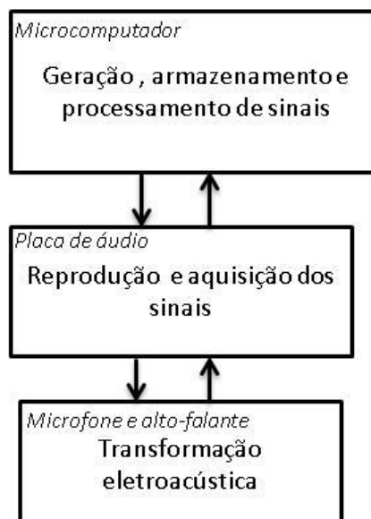
Figura 7 – Arquitetura do sistema de medição
