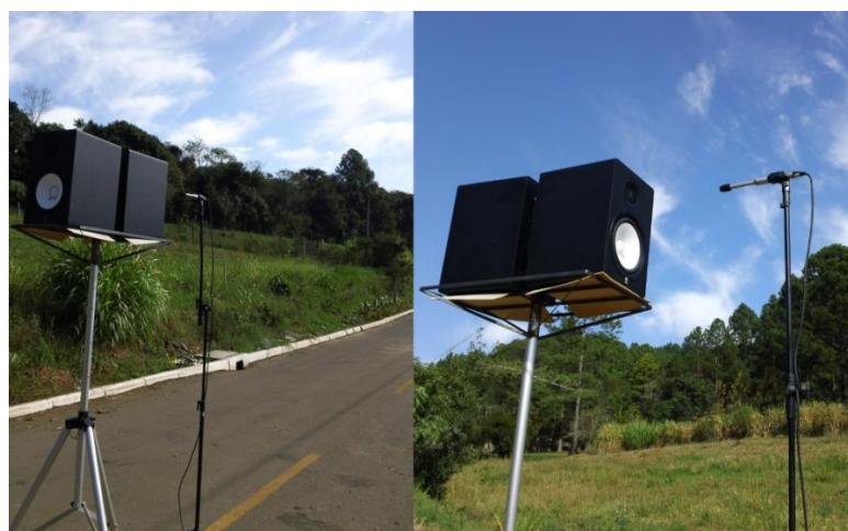
Figura 21 – Ambiente utilizado para medição em campo livre
