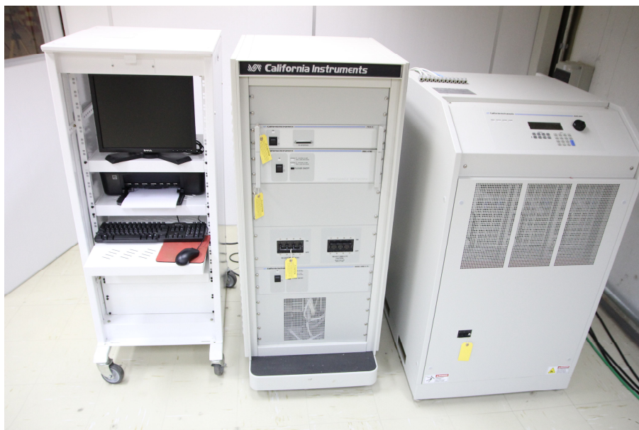
Figura 9 - Fonte trifásica para ensaio de qualidade de energia do CIENTEC
