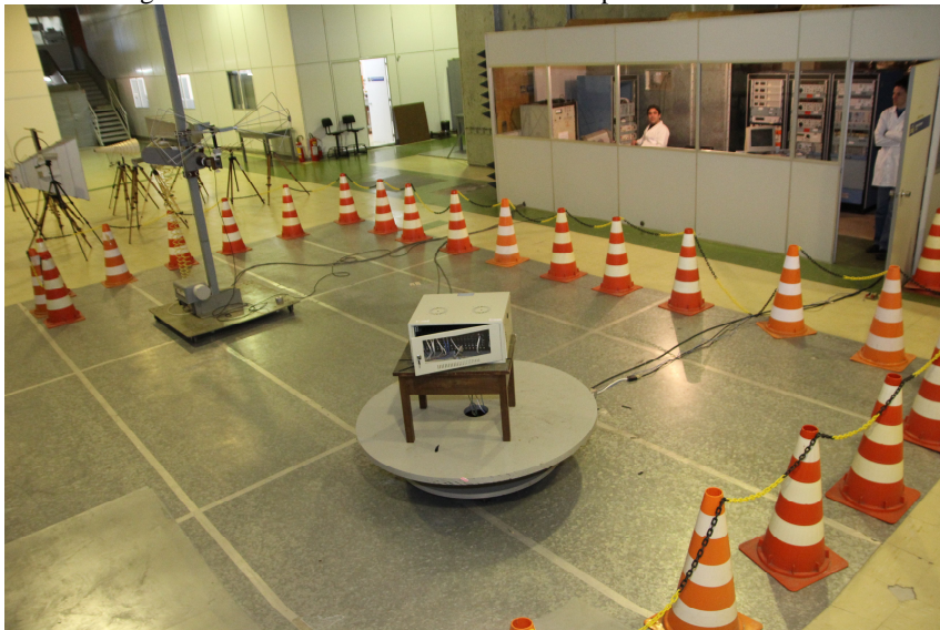
Figura 18 – Teste de emissão irradiada campo aberto CIENTEC.
