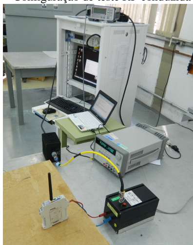
Figura 34 – Configuração de teste RF conduzida CIENTEC
