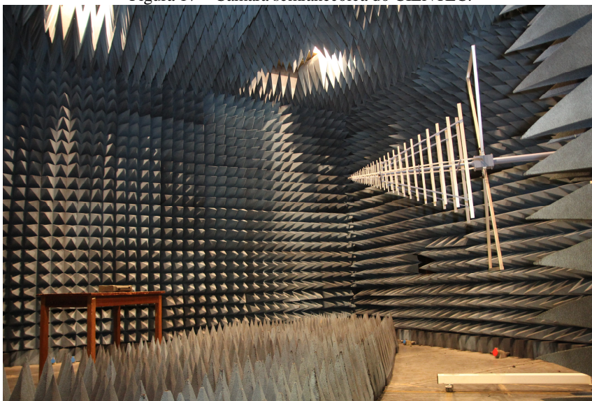
Figura 17 – Câmara semianecóica do CIENTEC.
