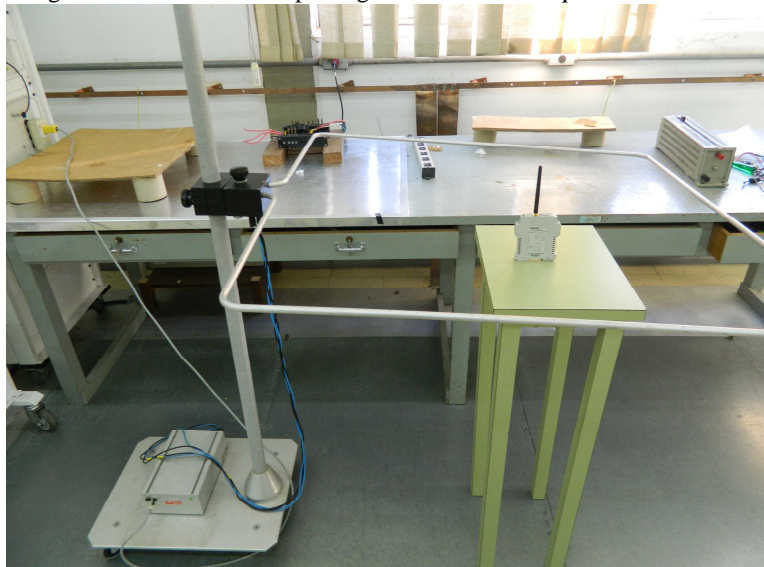
Figura 36 – Ensaio de campo magnético de baixa frequência CIENTEC.
