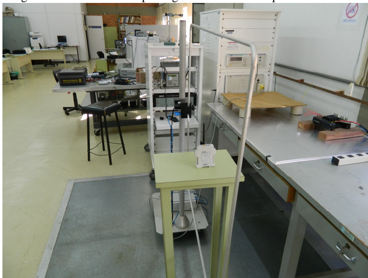
Figura 37 – Ensaio de campo magnético de baixa frequência CIENTEC.
