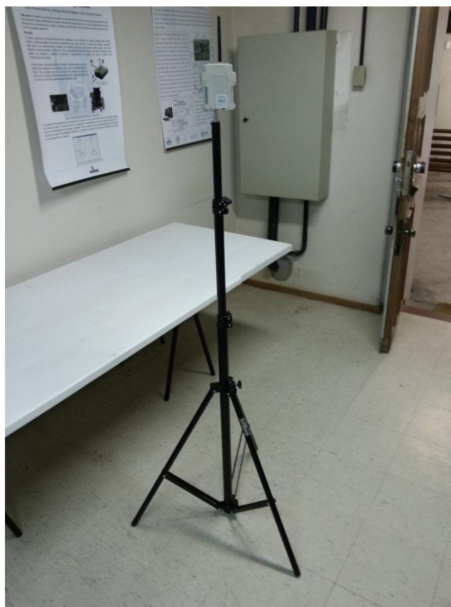
Figura 15 - Nó mestre da rede posicionada em tripé.
