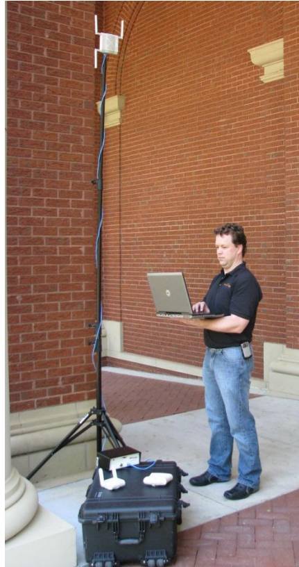
Figura 14 - Exemplo de estrutura empregada em Survey tipo Onsite [23].
