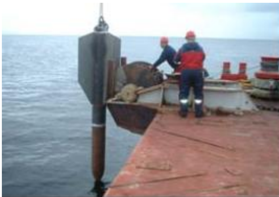
Figura 9 – Modelo de teste de estaca torpedo na Noruega em 2003
