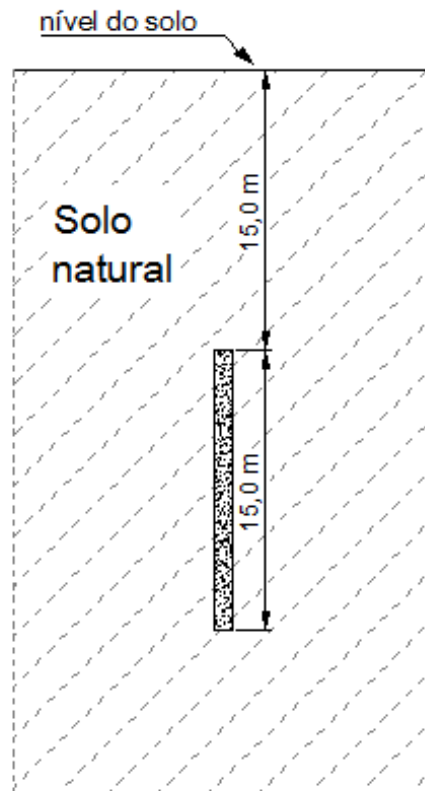
Figura 2 – Posição da estaca no interior do solo
