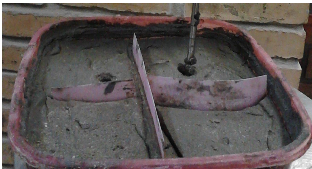
Figura 27 – Mistura moldada em recipiente para o ensaio de cravação de base alargada
