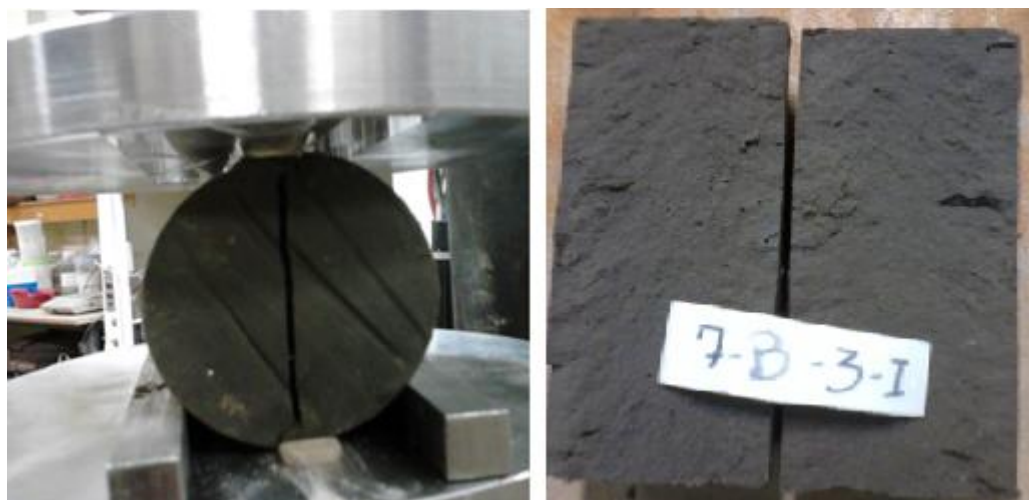
Figura 29 – Ruptura do corpo de prova
