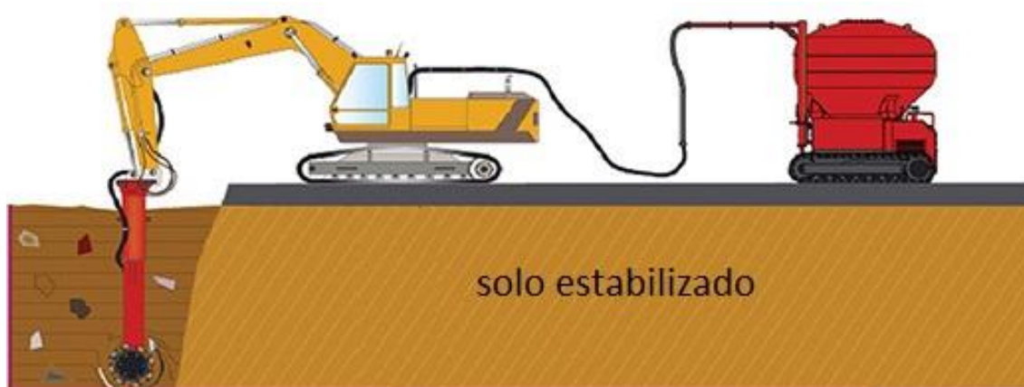
Figura 3 – Estabilização em massa
