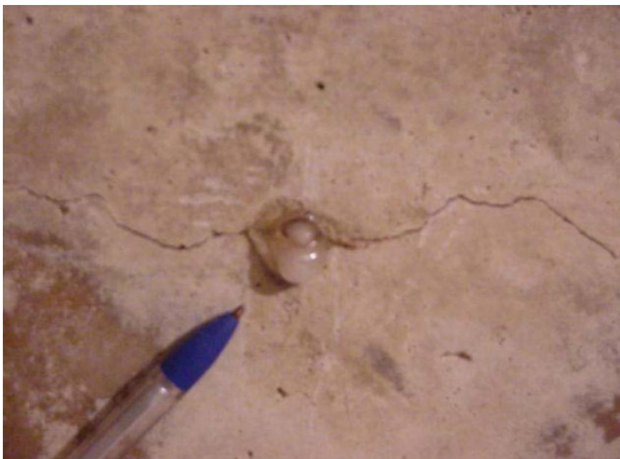
Figura 7: gel sílico-alcálico formado pela reação entre os agregados reagentes e o cimento (HASPARYK, 2005)
