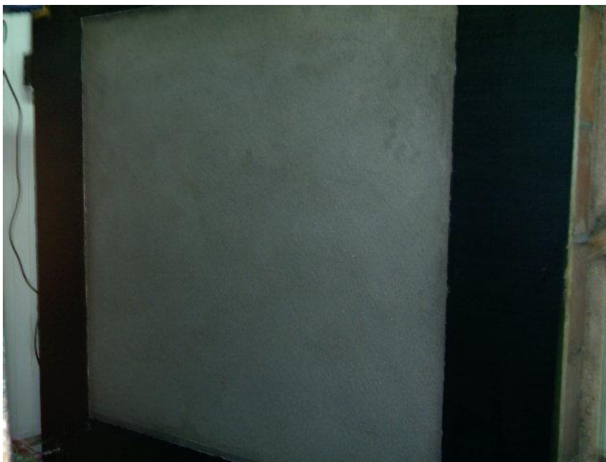
Figura 19 – Painel de argamassa de traço T1 confinado na câmara climatizada
