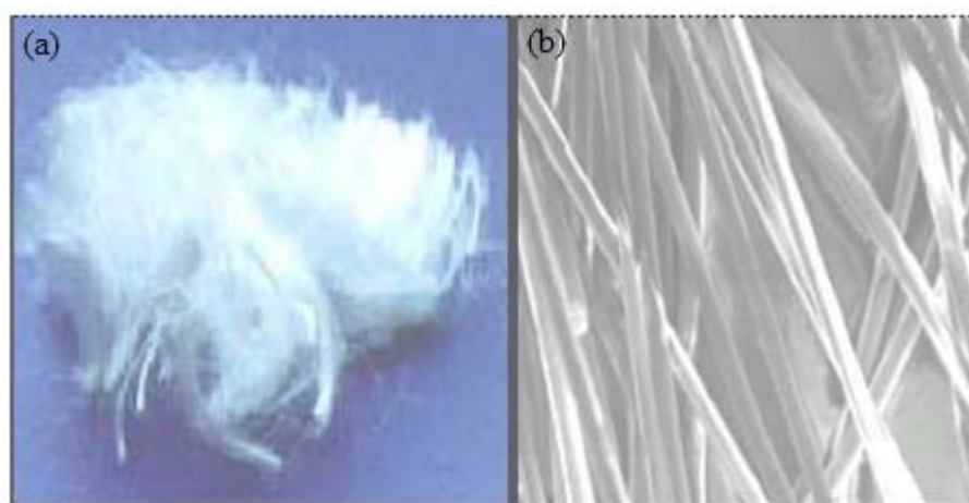
Figura 18 – (a) fibras de polipropileno cortadas com comprimento de 24 mm e (b) imagem de microscopia eletrônica de varredura com aumento de 230x
