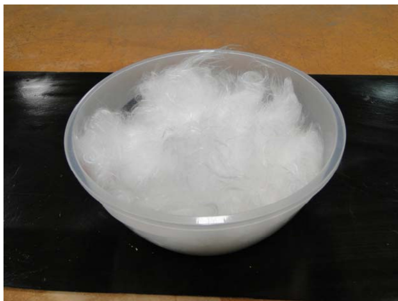
Figura 19 – Fibra de polipropileno lava e desfiada
