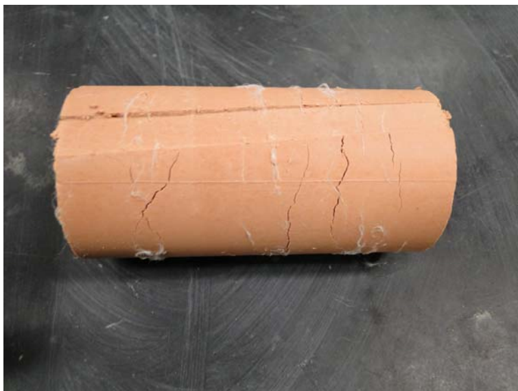
Figura 37 – Modo de ruptura de misturas solo-cal-fibra quando submetidas à compressão diametral
