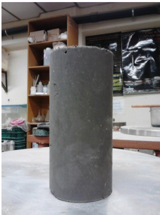
Figura 27 – Corpo de prova desmoldado para ensaio de tração por compressão diametral
