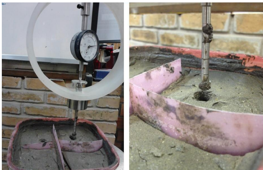
Figura 32 – Execução do ensaio de cravação
