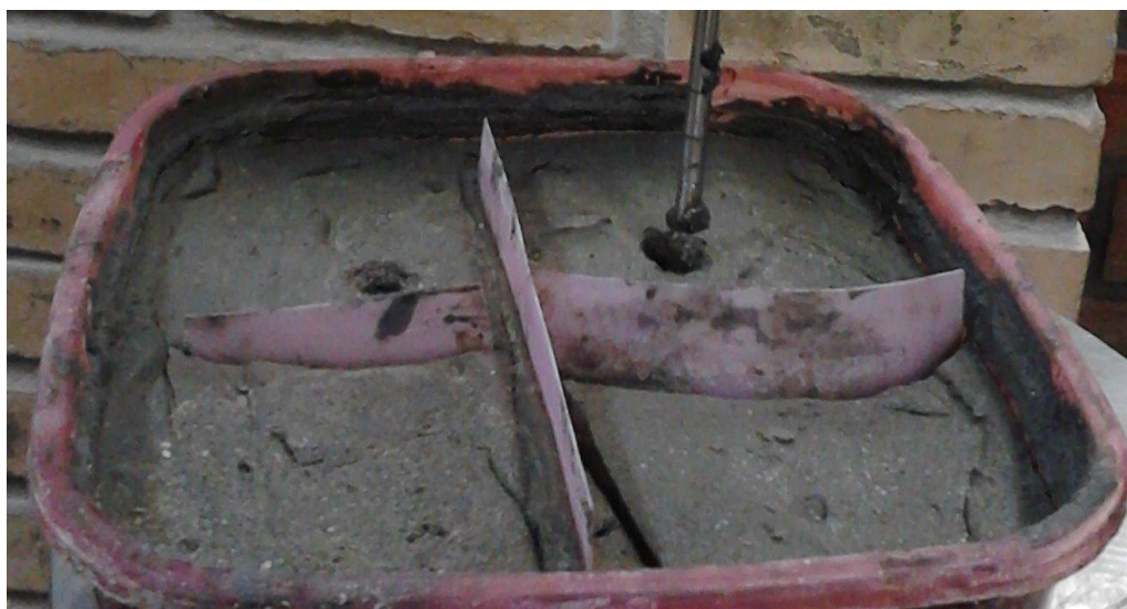
Figura 28 – Unidade de teste para o ensaio de cravação de base alargada
