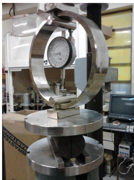
Figura 30 – Prensa hidráulica e anel dinamométrico
