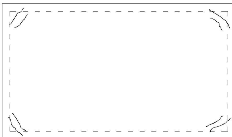
Figura 11 – Vista superior de uma laje simplesmente apoiada com fissuras por flexão
