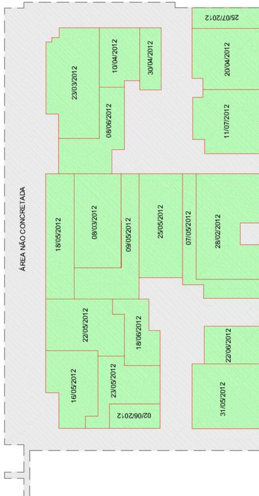
Figura 10 – Etapas de concretagem
