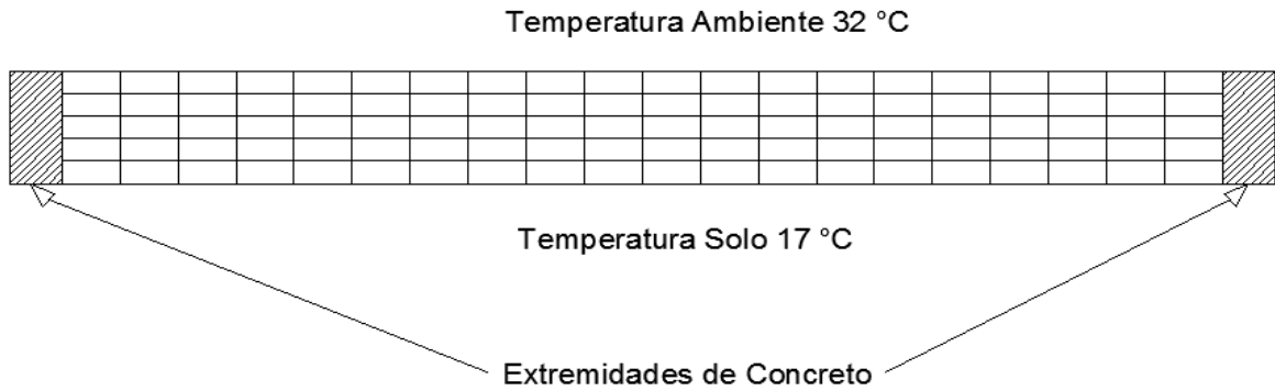
Figura 16 – Condições de contorno análise térmica
