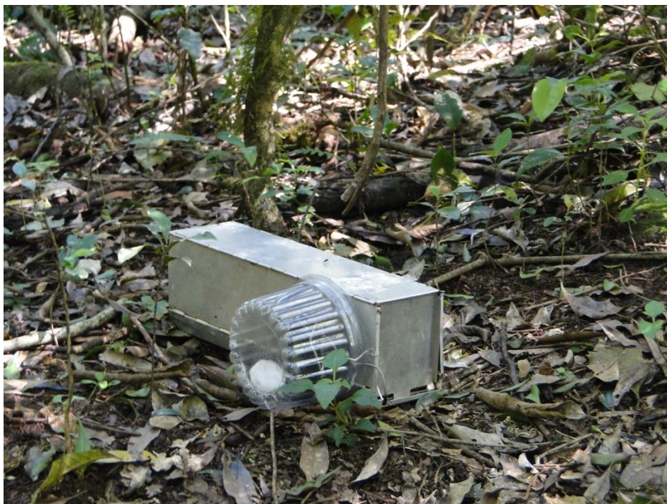
Figura 4. Armadilha Sherman fechada, acoplada com sistema de determinação do horário de captura.
