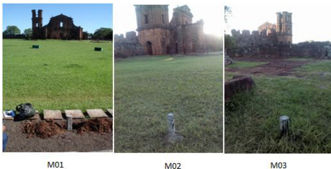
Figura 3-6 – Marcos geodésicos da rede geodésica local
