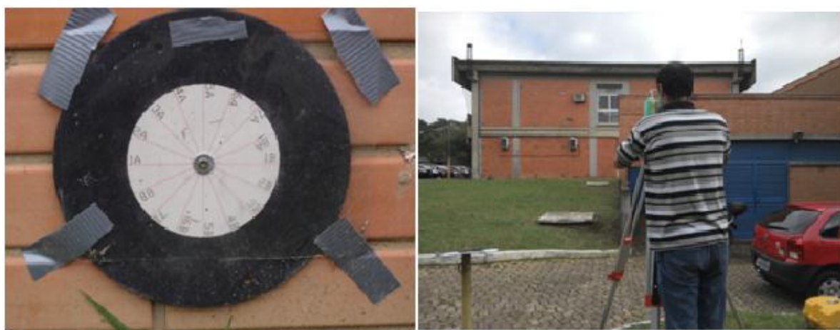
Figura 3-13 – Detalhe do alvo e medição topográfica do campo de calibração
