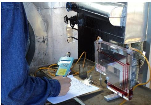
Figura 22 – Manômetro de tubo em U inclinado.
