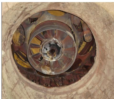
Figura 5b- Bico ejetor de gás do queimador 3.
