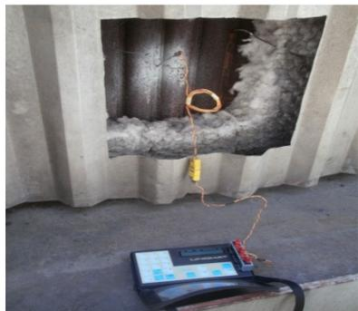
Figura 14a - Fixação do condúite de termopar na aleta da parede d'água.
