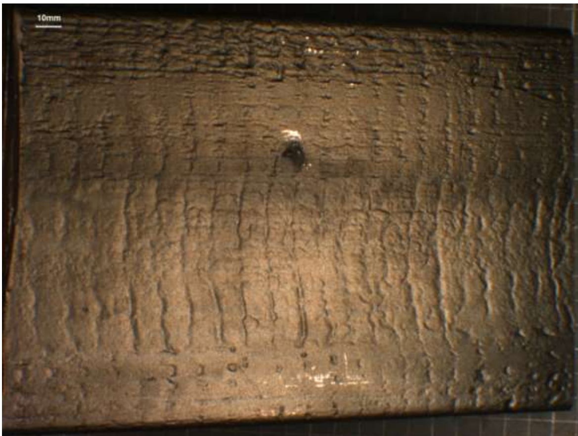
Figura 44. Detalhe das marcas de oscilação da condição 4.
