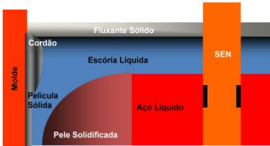
Figura 28. Esquema dos componentes que envolvem a região superior interna do molde.
