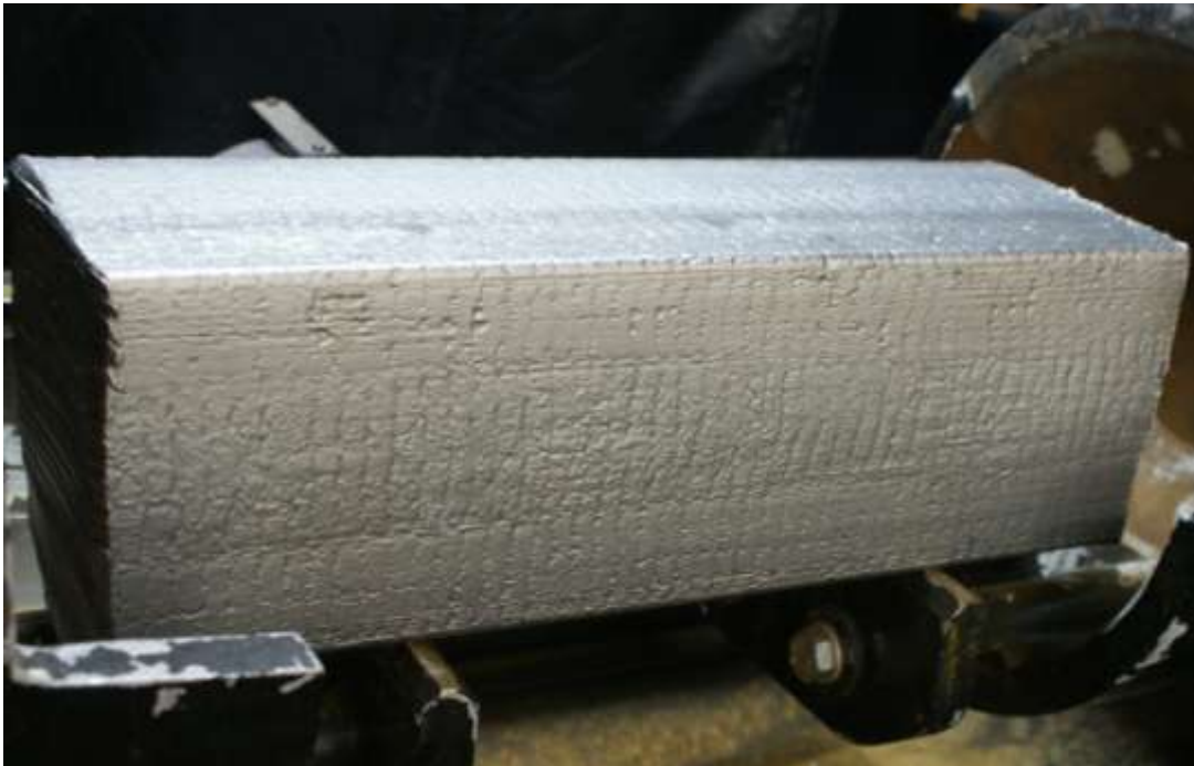
Figura 31. Amostra do tarugo com jateamento para caracterização das marcas.
