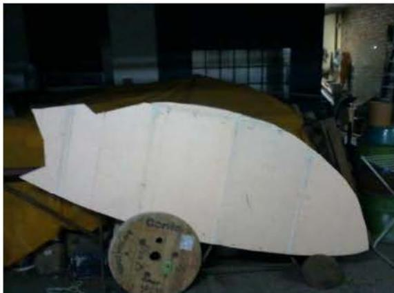
**Figura 76: construção do perfil central escala 1:1 em Isofoam**
