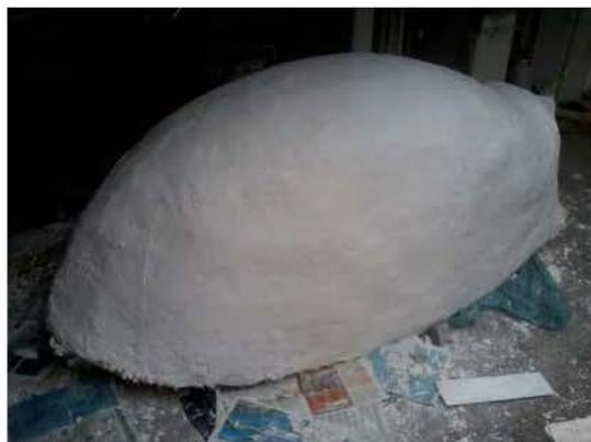
Figura 79: aplicação de gesso para regularização da superfície
