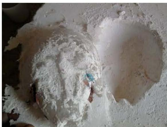
**Figura 47: extração do corpo laminado em fibra de vidro** Fonte: autor
