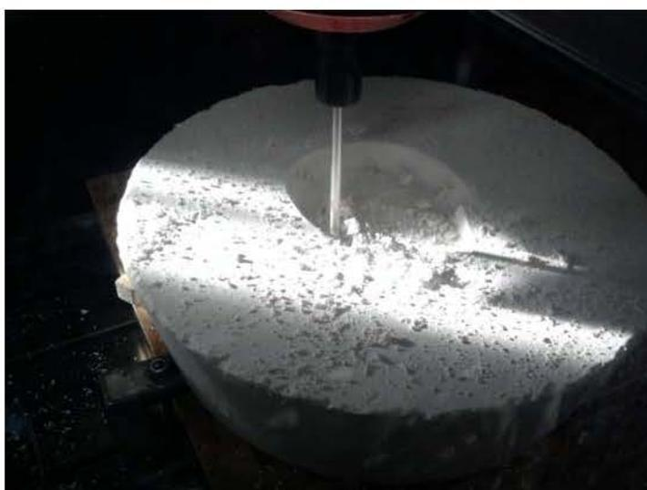
**Figura 46: usinagem do bloco de gesso com equipamento de CNC do LDSM**
