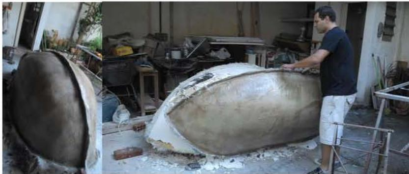
**Figura 81: após secagem de 24h foi removida pré-forma do modelo em gesso**
