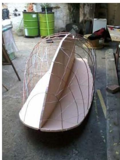
**Figura 77: estruturação do aramado para dar a forma desejada**
