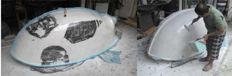
**Figura 80: aplicação de filme plástico e gelcoat para execução da pré-forma**
