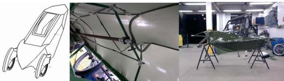
Figura 66: teste aplicação de tecido + resina sobre estrutura
