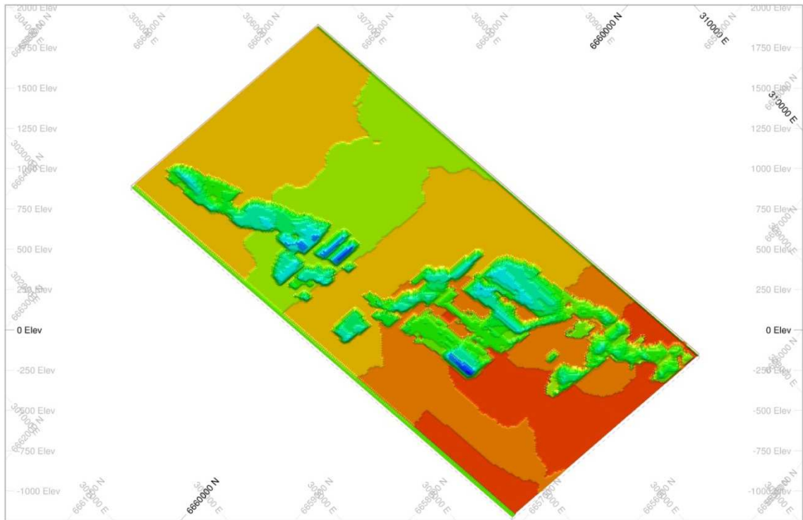
FIGURA 45 – Estado da cava no final do 17º e último ano de vida da mina com um total de 150,110,460 t de minério extraídas
