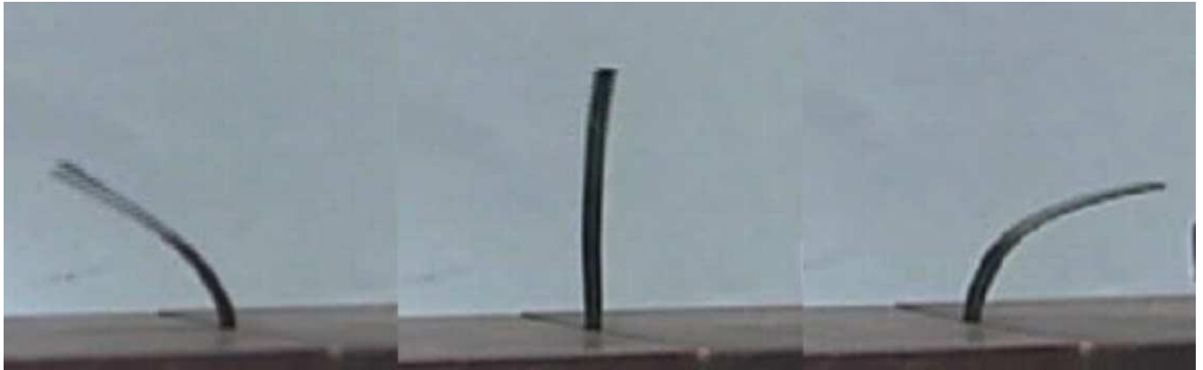
Figura 13 IPMC em funcionamento com tensão de 1,5V
