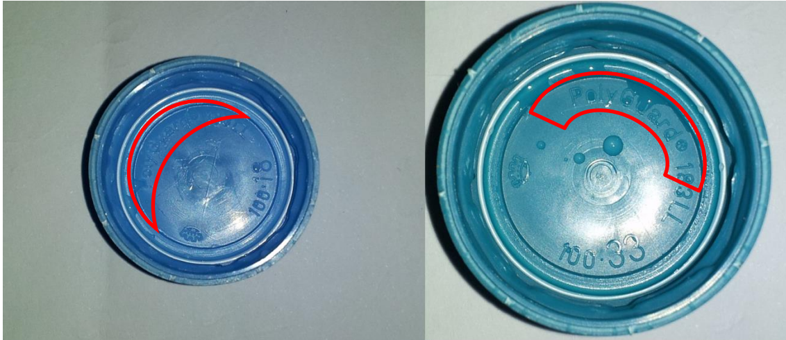
Figura 7. Identificação do material da tampa da garrafa por inspeção visual em diferentes marcas
