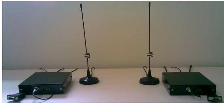
Figura 30 – Transmissor e receptor de dados
