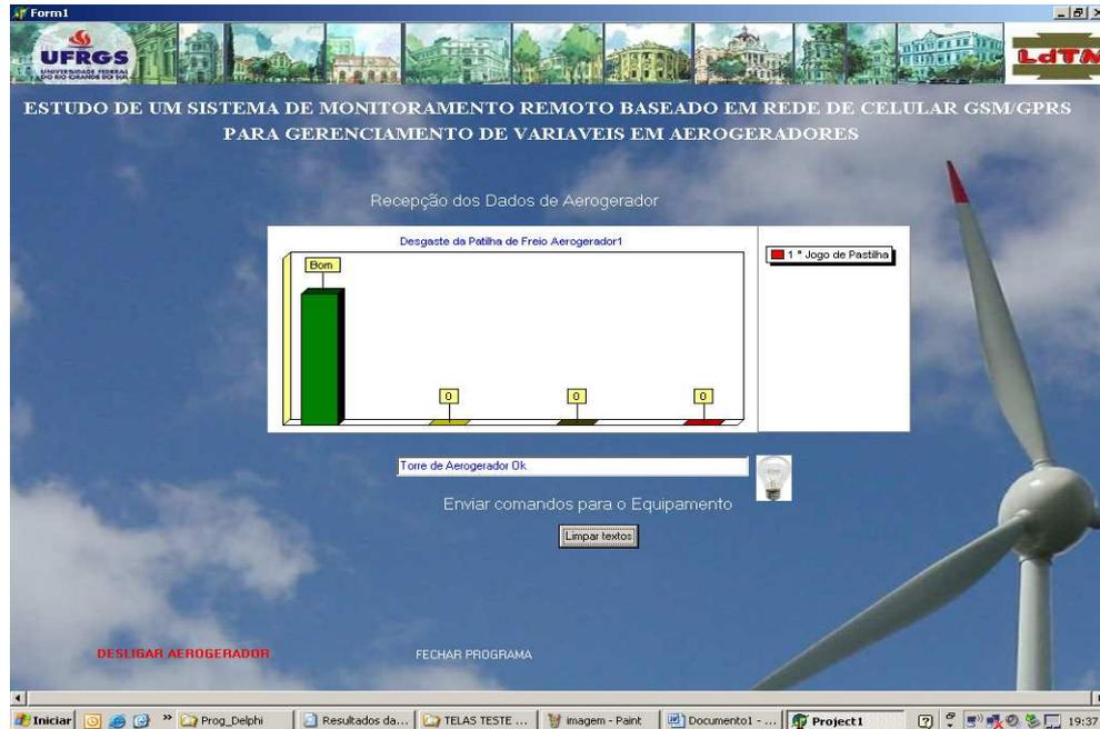
Figura 32 – Tela torre do Aerogerador Ok (lâmpada branca) aparecendo para o operador, referente simulação de vibração da torre
