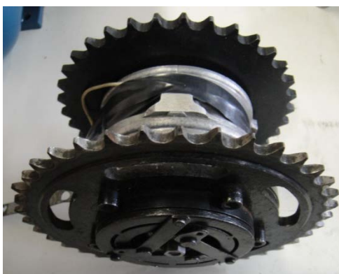
Figura 4.4.7 – Embreagem com desalinhamento no próprio eixo.
