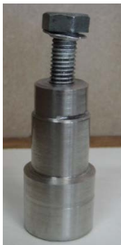
Figura 4.4.5 – Eixo com rosca desalinhada.
