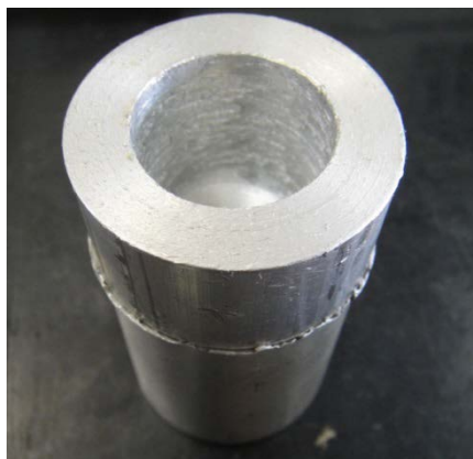
Figura 4.4.8 – Bucha usinada em alumínio.
