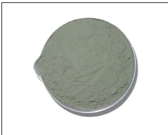
Figura 3.3: Cinzas da Serragem da Operação de Rebaixamento geradas em escala de laboratório(CSR-lab)
