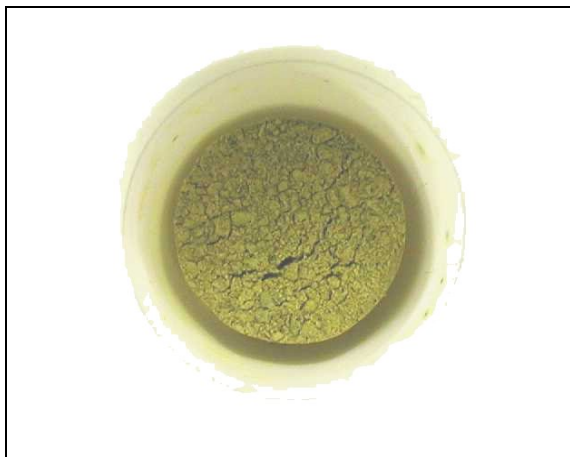
Figura 3.8: Cromato de sódio(VI) produzido a partir do óxido de cromo presente nas cinzas da serragem da operação de rebaixamento
