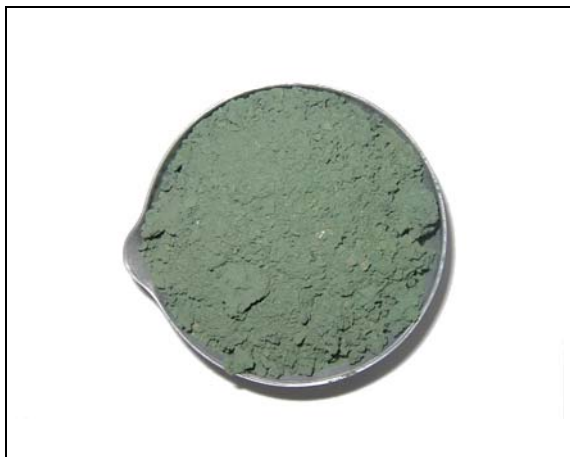
Figura 3.5: Cinzas das Aparas de Couro provenientes do Reator de Gaseificação (CAC-RG)
