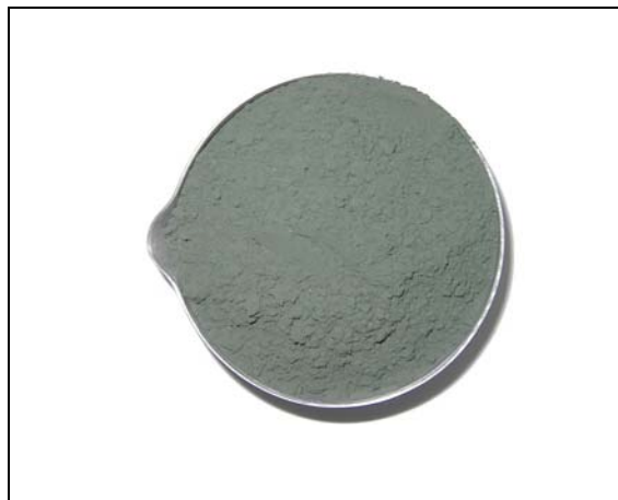
Figura 3.6: Cinzas das Aparas de couro provenientes do Ciclone (CAC-Ci)
