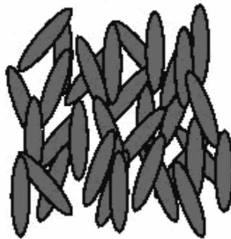
**Figura 2.7:** Representação de um conjunto de moléculas na fase nemática.
