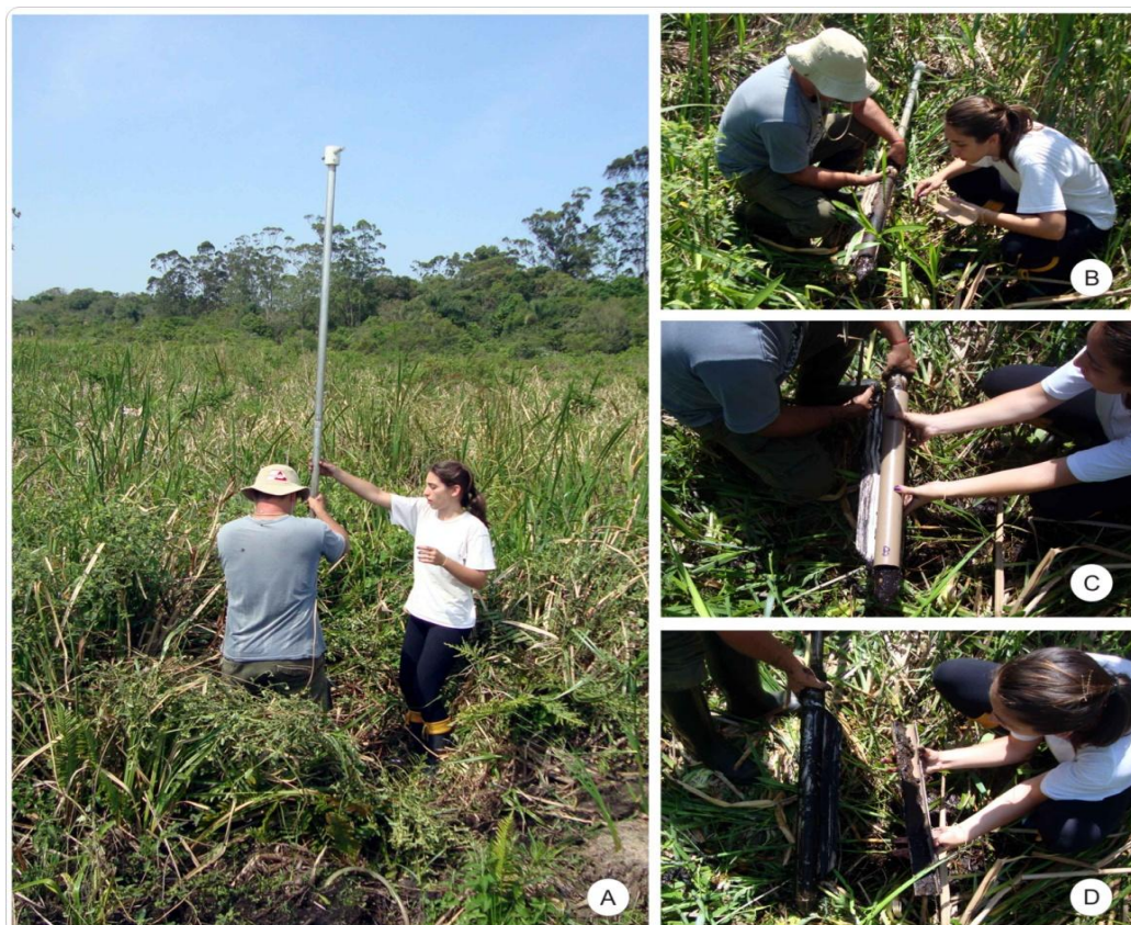
Figura 6: Coleta utilizando o aparelho Russian Peat Borer . A coleta do testemunho é realizada em seções de 50 cm cada, até atingir a profundidade desejada (A, B) e é transferida para tubos de PVC que contém o registro da profundidade da seção (C, D).
