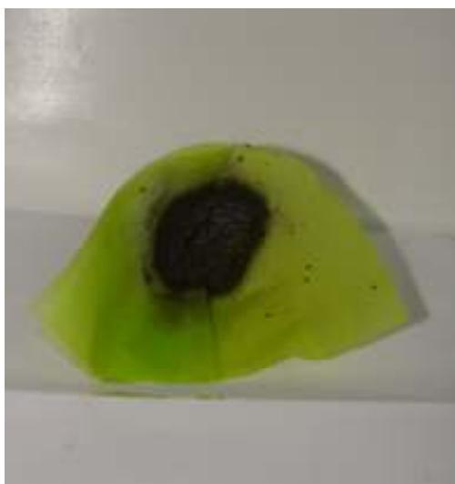
**Figura 9:** Papel filtro com o material que ficou retido após a caracterização das PCI's
