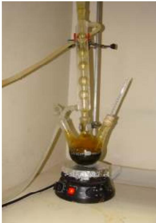
**Figura 7:** Digestão química das placas de circuito impresso com água-régia em um balão com refluxo para posterior caracterização química.
