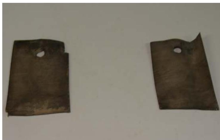
**Figura 11:** Placas de prata após processo de lixiviação
