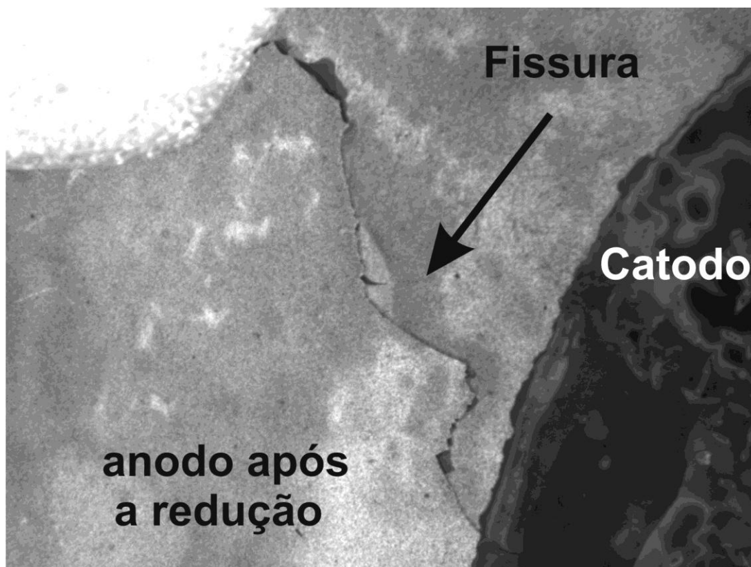
Figura 6.23: Detalhe do rompimento do anodo após o teste eletroquímico a temperaturas superiores a 650°C.
