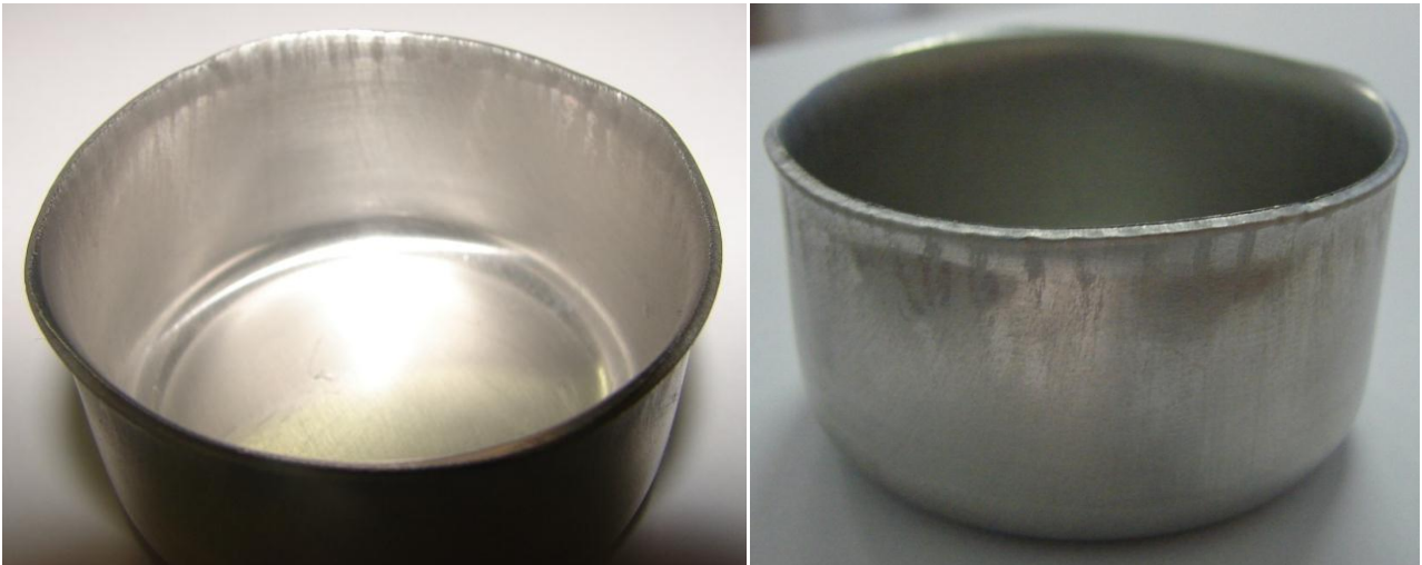
Figura 55. Peça que foi estampada com lubrificante de graxa e com as matrizes lixadas a 1200.
