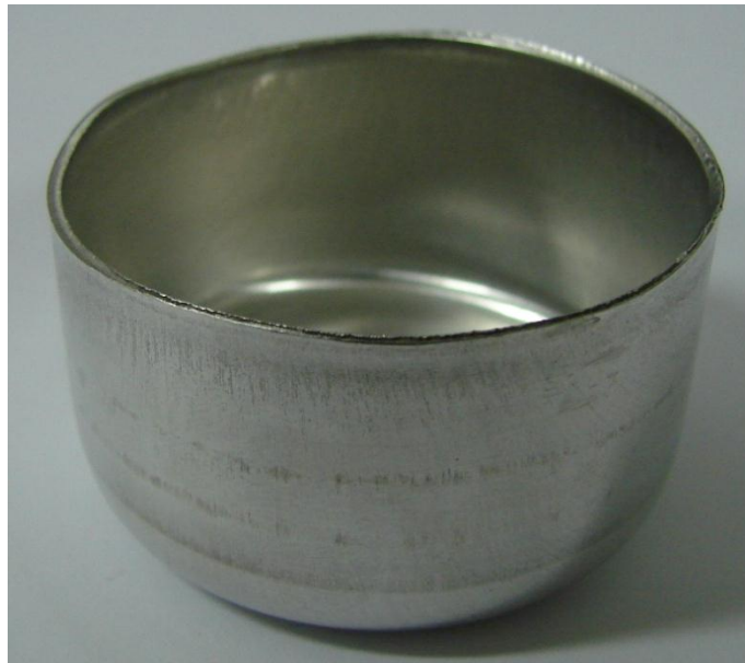
Figura 53. Peça estampada ao qual não apresentou enrugamento.
