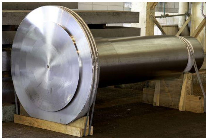
Figura 5: Eixo maciço aplicado em aerogeradores de energia, após usinado. Cortesia: Villares Metals .
