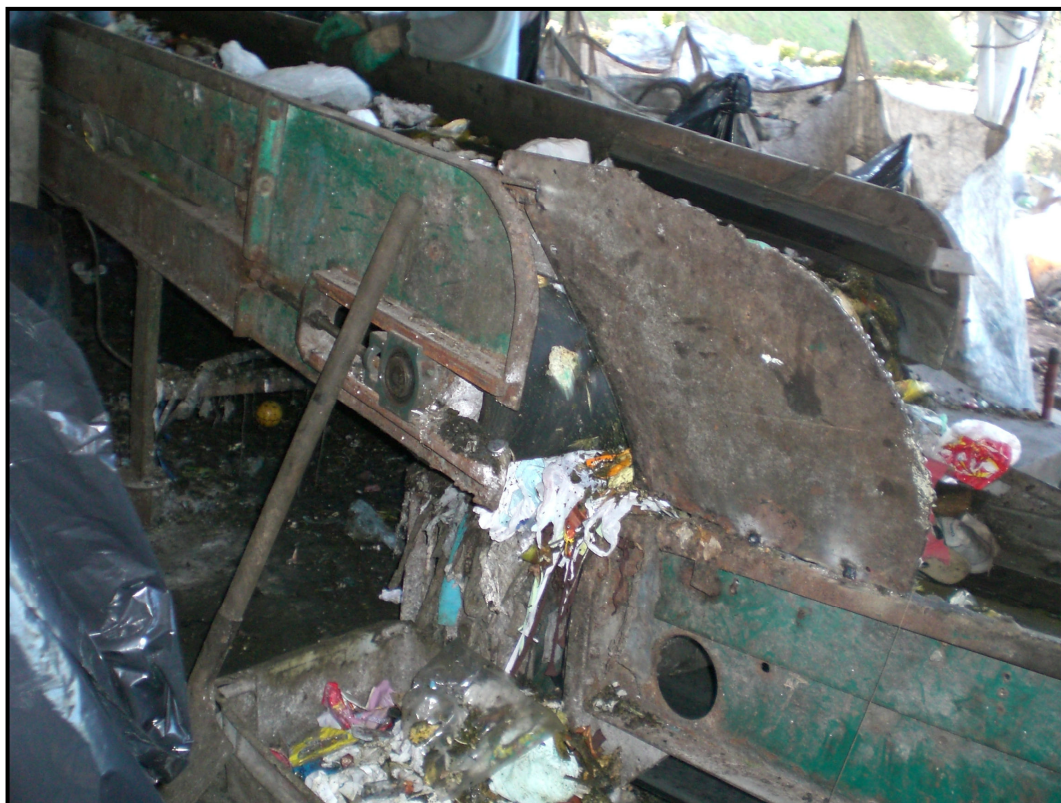
Figura 5.1: Junção entre dois diferentes níveis da esteira de triagem.
