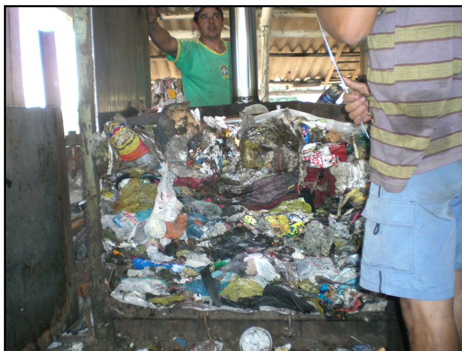
Figura 5.17: Foto do fardo de rejeito compactado ao final do ensaio.
