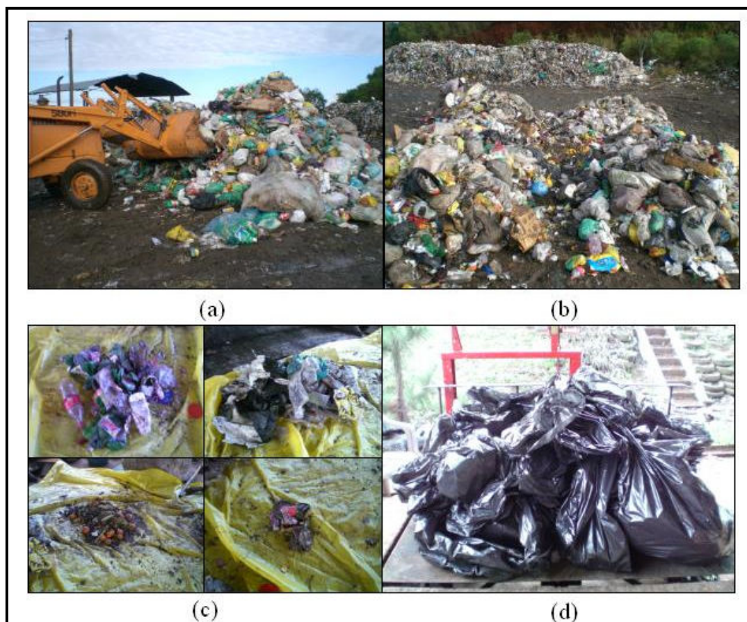
Figura 4.4: Fases da operação - (a) quarteamento do resíduo, (b) material quarteado, (c) separação do material e (d) pesagem das amostras.
