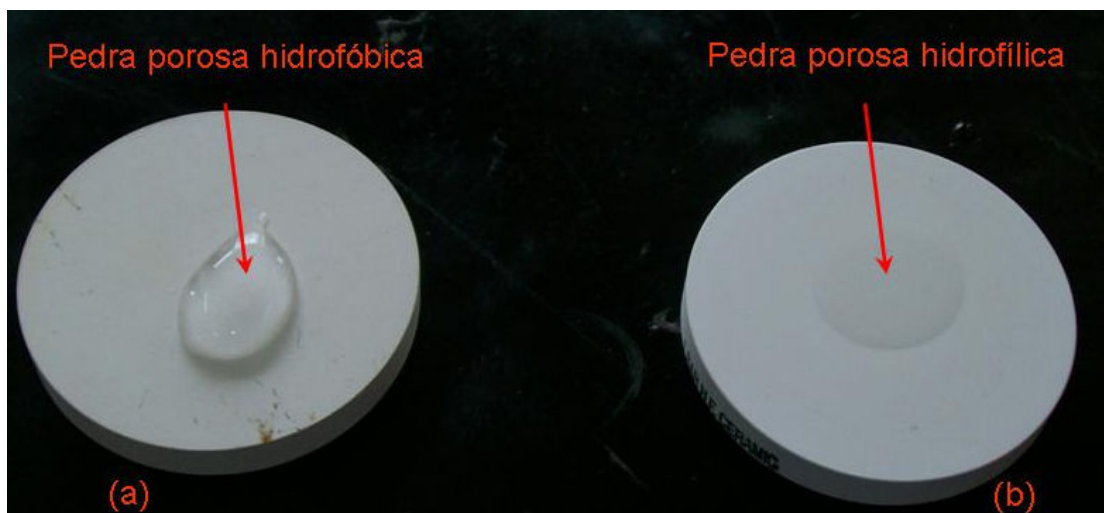
Figura 3.3: Visualização comparativa entre a pedra porosa (a) hidrofóbica e (b) hidrofílica.
