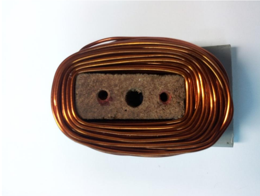
Figura 58 Modelo experimental das bobinas de fase de um polo.
