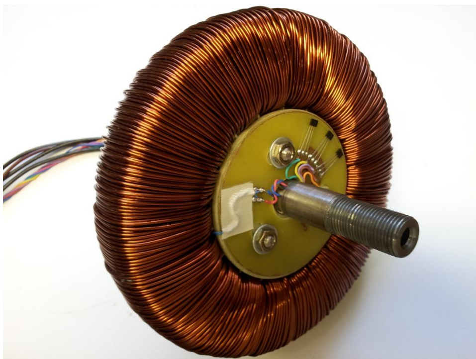
Figura 92 Estator visto pelo lado dos sensores.
