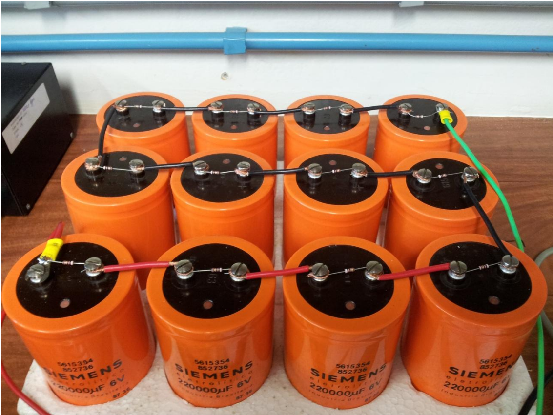
Figura 113 Banco de capacitores utilizado para o ensaio de frenagem regenerativa.
