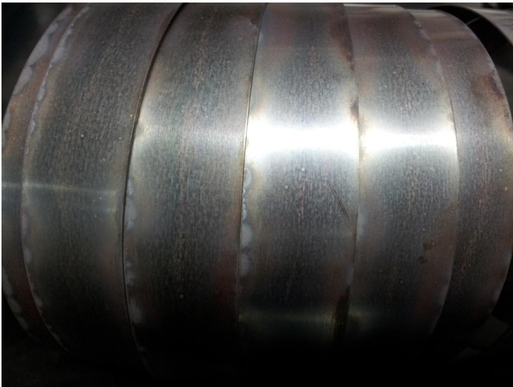
Figura 33 Amostra da fita de aço ao silício retirada do núcleo de número 3.
