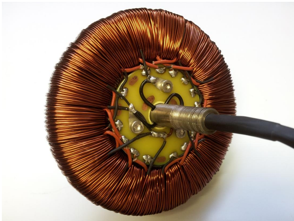
Figura 91 Estator com as conexões do circuito de armadura.
