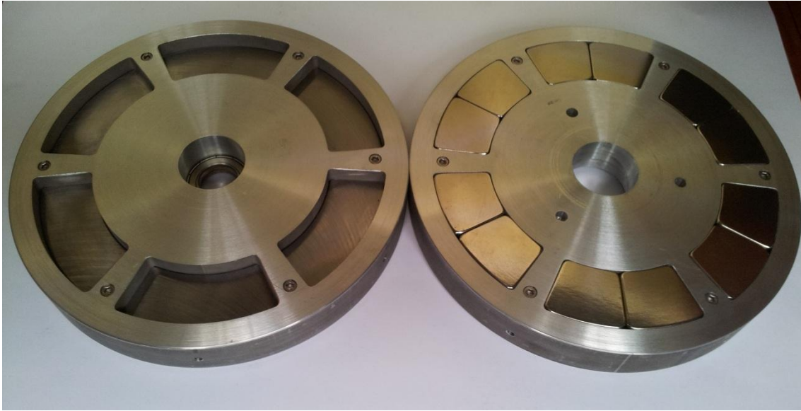
Figura 89 Rotores para o protótipo, sem e com os ímãs permanentes.
