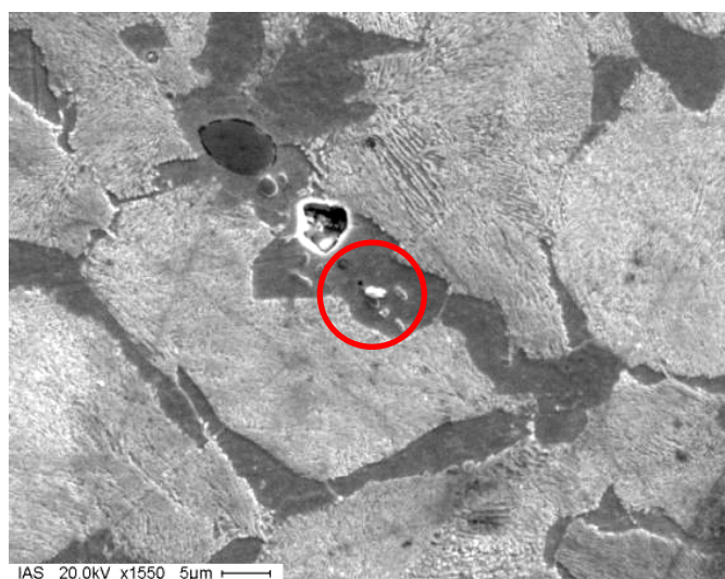
Figura 4-59 Amostra correspondente à região do núcleo de uma barra laminada não-abafada apresentando precipitação de Ag – vinculada a presença de hidrogênio – associada a um MnS. No detalhe, resultado da análise EDS efetuada sobre a partícula corroborando a presença de Ag (vide pico indicado no espectro).
