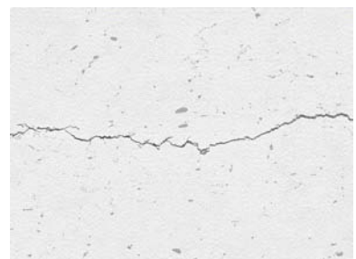
Figura 9-61 Micrografia da região da trinca com estrutura bainítica.
