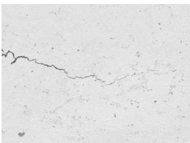
Figura 9-59 Micrografia da região da trinca com estrutura bainítica.
