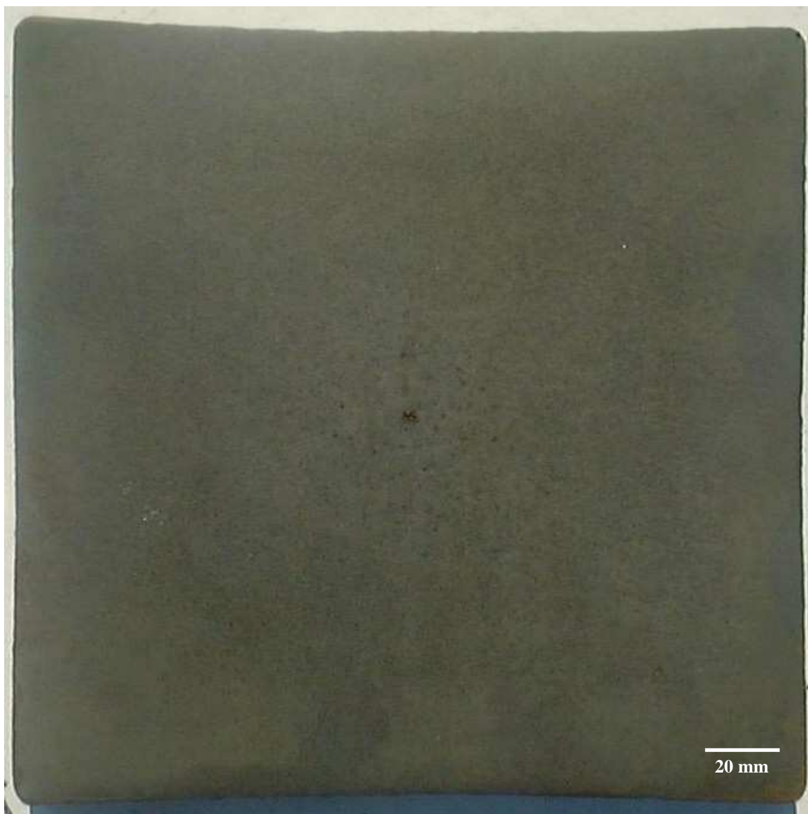
Figura 4-25 Macrografia referente aos tarugo elaborados sem FEMS , de final de LC.
