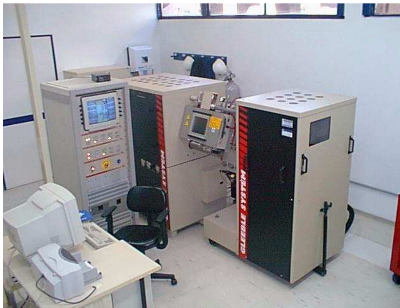
Figura 3-2 Simulador físico Gleeble 3500. (34)
