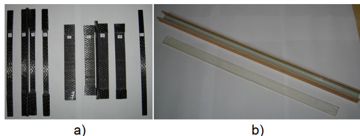
Figura Al.2. CPs: a) de material compósito, b) de resina epóxi,
