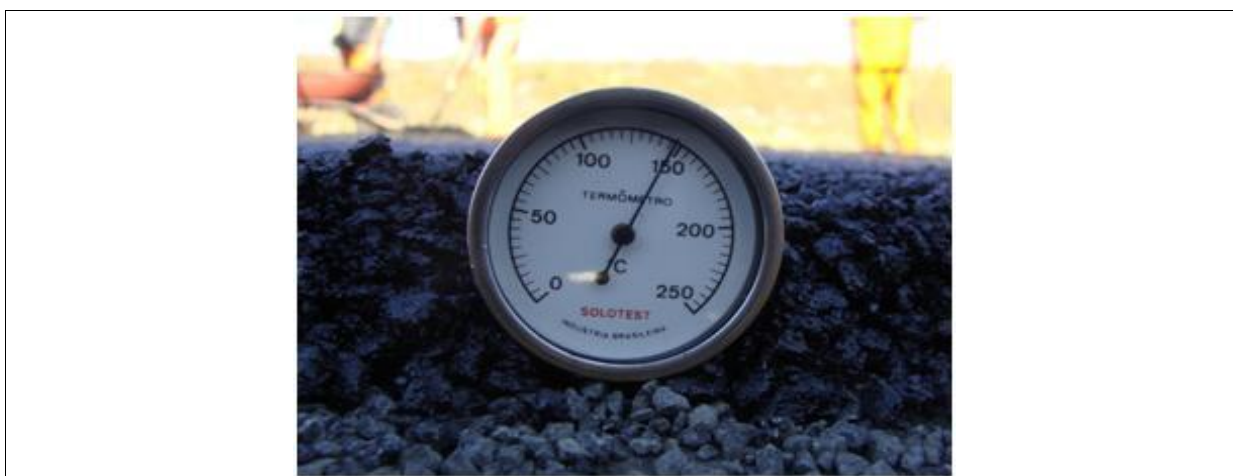
Figura 4.23: Temperatura média de distribuição da mistura asfáltica para o RAUD no trecho experimental
