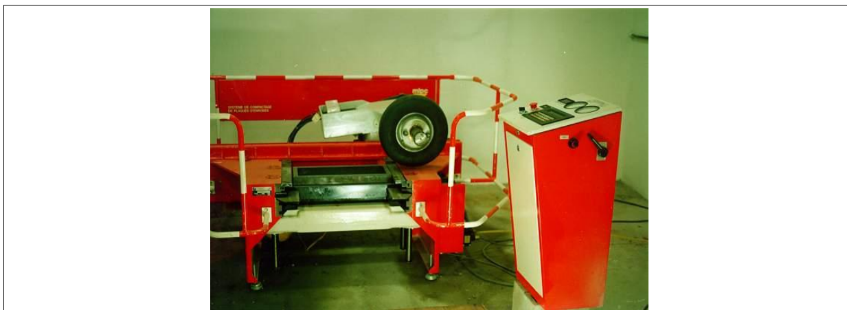
Figura 3.59: Mesa compactadora tipo LPC ( Laboratoire des Ponts et Chaussées )
