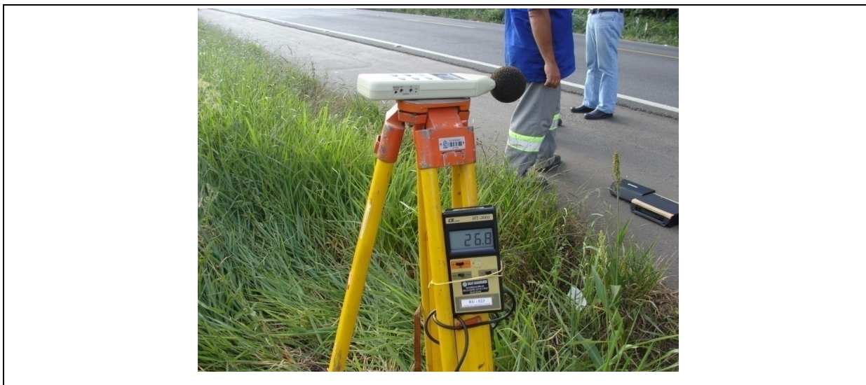
Figura 4.38: Detalhe do equipamento utilizado para a medição do ruído - metodologia ISO 11819-1 ( Statistical Pass-By Index ) nesta pesquisa
