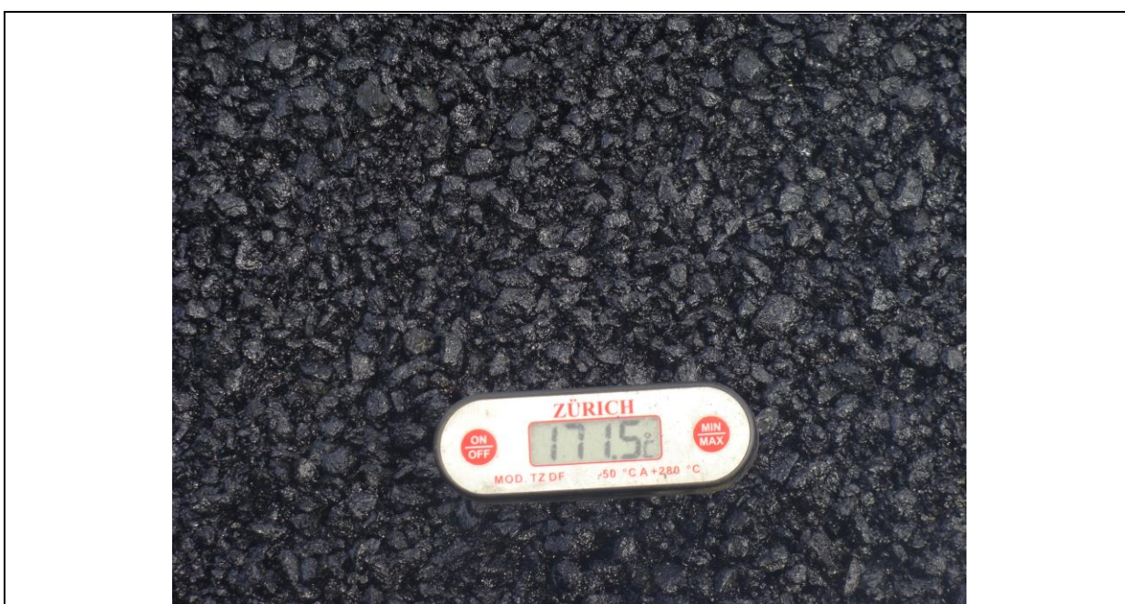
Figura 12: Transporte da mistura - temperatura da massa asfáltica
