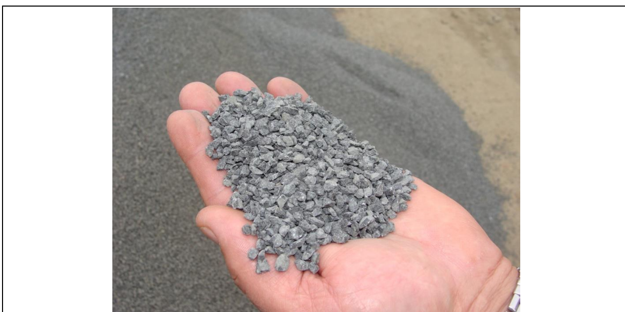
Figura 4: Detalhe da graduação do agregado 4/6 mm para a camada impermeabilizante e de ligação do RAUD
