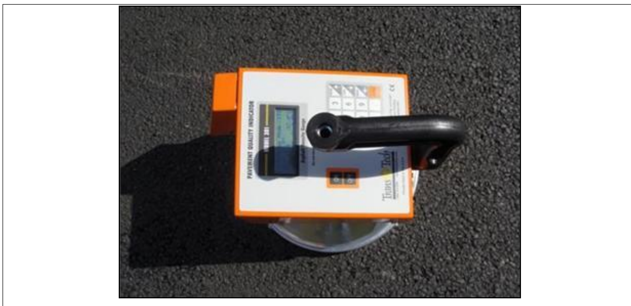
Figura 4.28: Determinação da densidade de referência da seção-teste (RAUD) através do densímetro eletromagnético.
