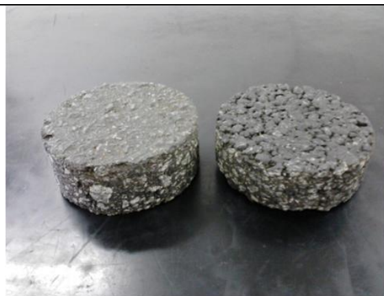
Figura 4.27 (b): Extração por sonda rotativa e CPs da pista experimental - detalhe dos CPs do CA (à esquerda) e do RAUD (à direita)
