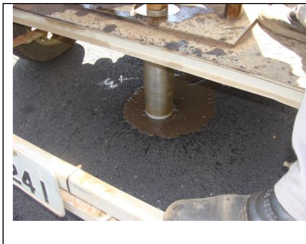
Figura 4.27 (a): Extração por sonda rotativa e CPs da pista experimental - extração de CPs por sonda rotativa
