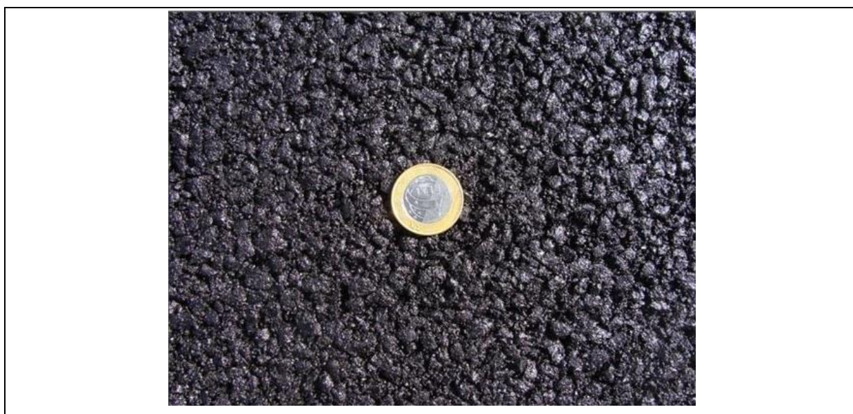
Figura 4.24 (b): Detalhes da espessura e textura superficial do RAUD – textura superficial da camada
