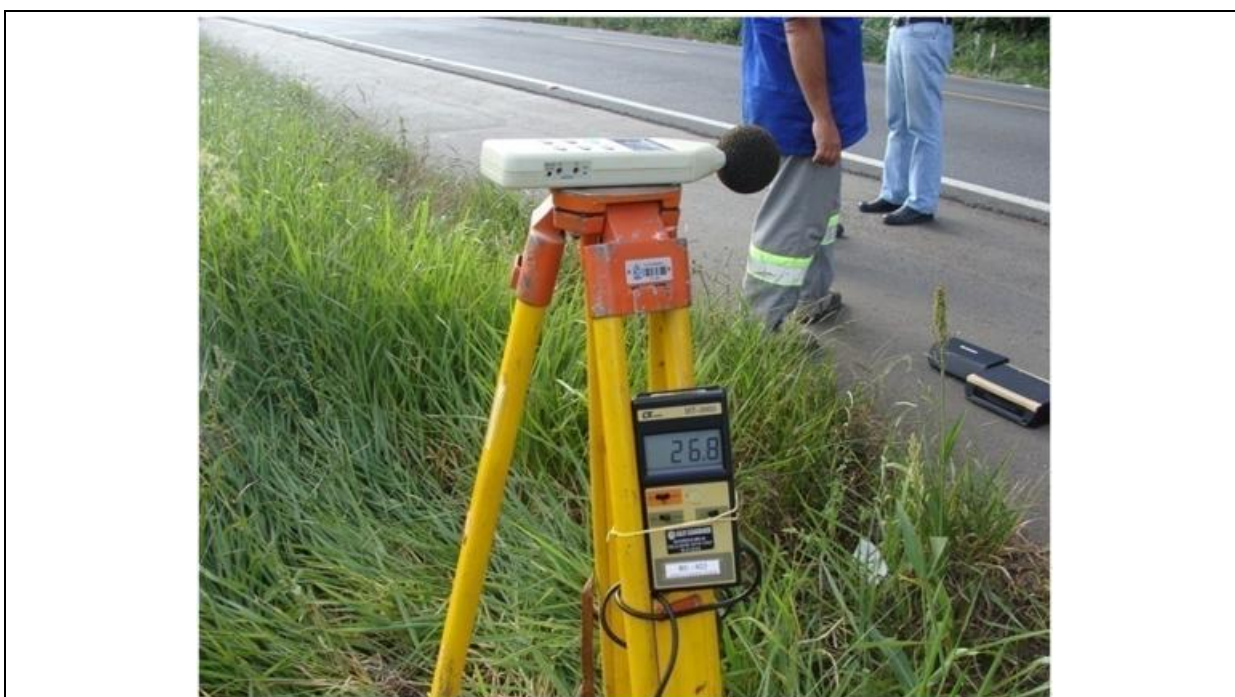
Figura 32: Monitoramento do trecho experimental – avaliação do ruído do trecho experimental – equipamento utilizado segundo o método isso 11819-1 ( statistical pass-by index )
