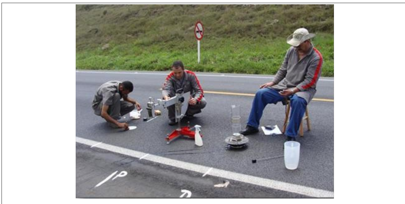
Figura 4.32: Detalhe da execução dos ensaios de macrotextura/ mancha de areia, microtextura/pêndulo britânico e drenabilidade na seção-teste (RAUD) do trecho experimental.
