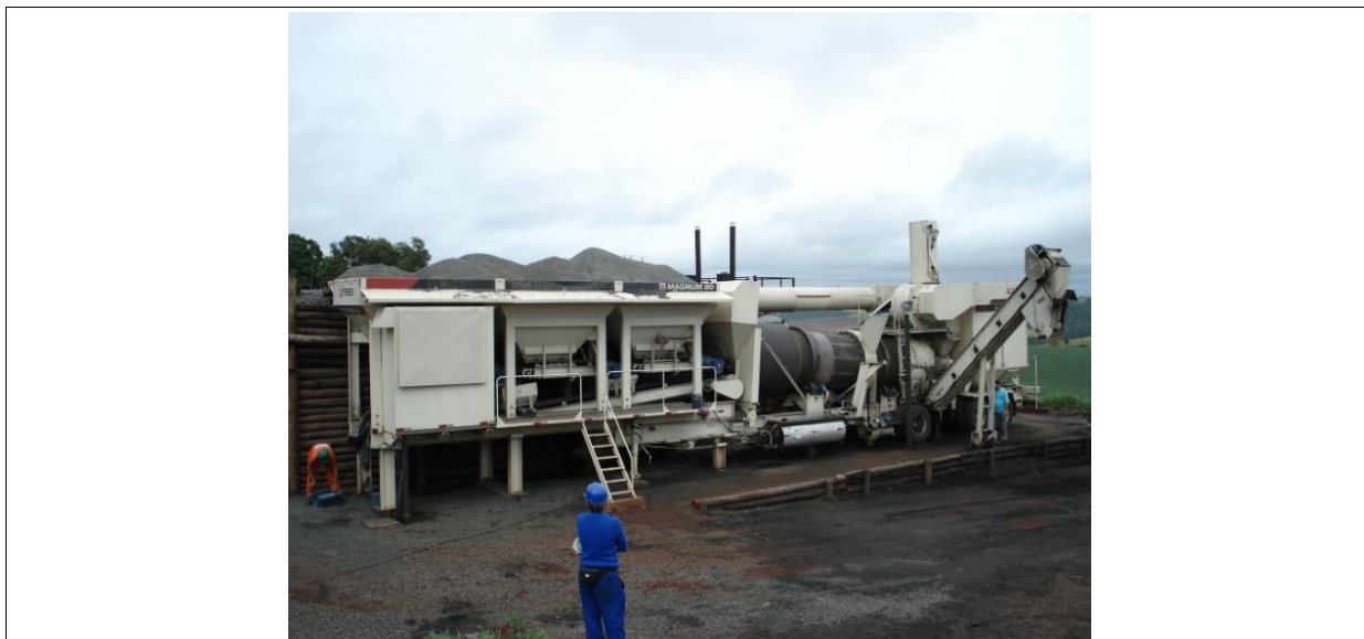
Figura 4.18: Usina de asfalto - MAGNUM 80 utilizada no trecho experimental
