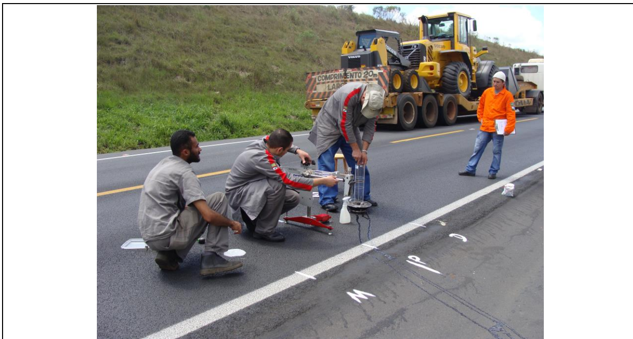
Figura 31: Monitoramento do trecho experimental – avaliação dos parâmetros funcionais do trecho experimental (macrotextura/mancha de areia, microtextura/pêndulo britânico e drenabilidade)
