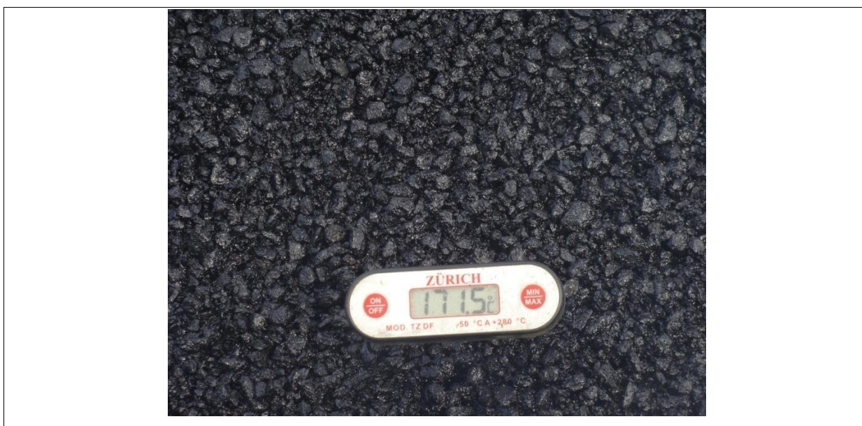
Figura 4.22: Temperatura de usinagem da mistura asfáltica para o RAUD
