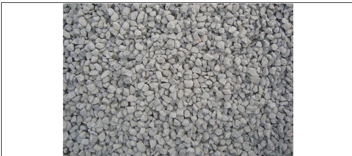
Figura 10: Produção da mistura - detalhe da forma cúbica do agregado graúdo selecionado para a composição da massa asfáltica
