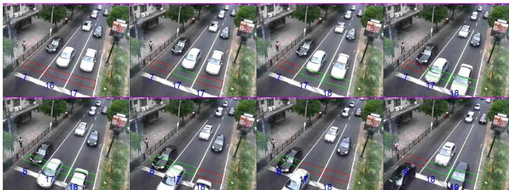
**Figura 46: Ativação dos laços virtuais e incremento dos respectivos contadores na Cam06.**
