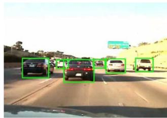
**Figura 15: Exemplo de rastreamento através de câmeras no interior de veículos de (SIVARAMAN e TRIVEDI, 2010).**
