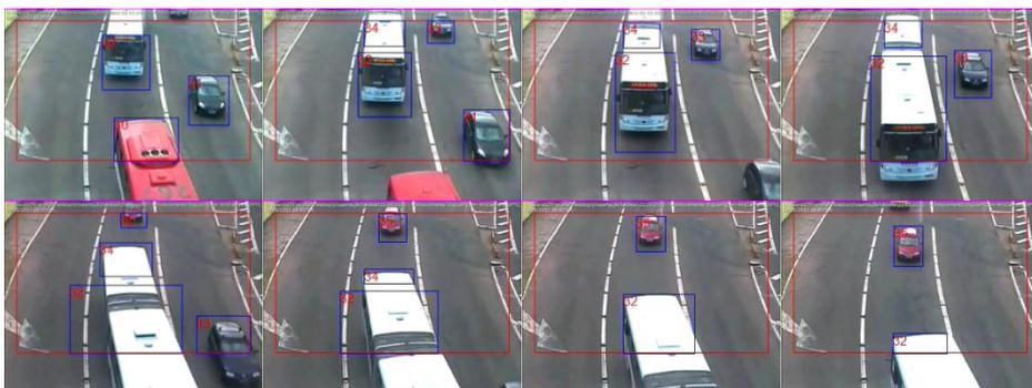
**Figura 57: Rastreamento de um veículo grande na Cam41, inicialmente identificado como dois objetos.**
