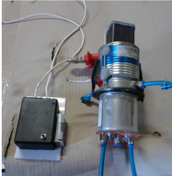
Figura 4.2 – Centelhador e queimador.
