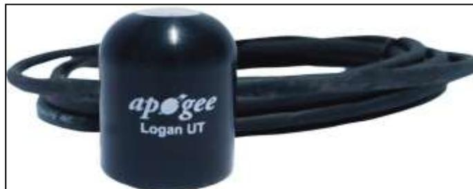
**Figura 7** - Sensor do tipo piranômetro.
