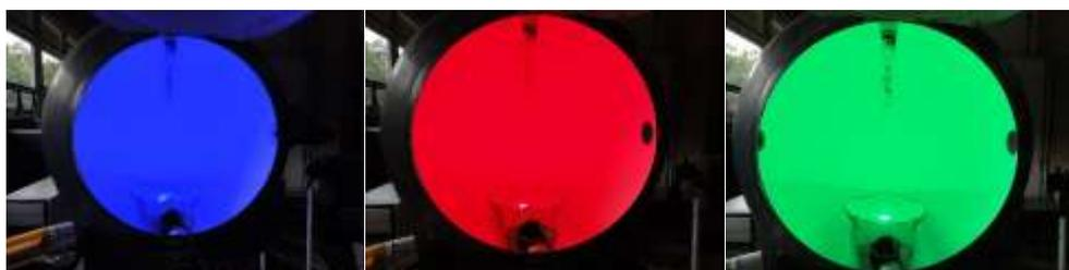
**Figura 5** - Lâmpadas na esfera de integração.
