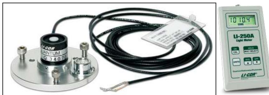
**Figura 8** - Sensor do tipo quantômetro com o seu medidor.
