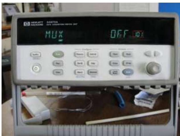
**Figura 9** – Data logger HP 34970A para aquisição de dados.
