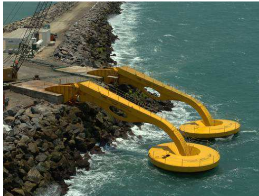
Figura 3.5: Usina de ondas no porto de Pecém, Ceará (Fonte: COPPE, 2012)
