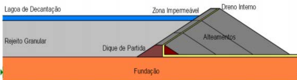
Figura 84. Ilustração do método a jusante utilizado para a construção da bacia de rejeito.
