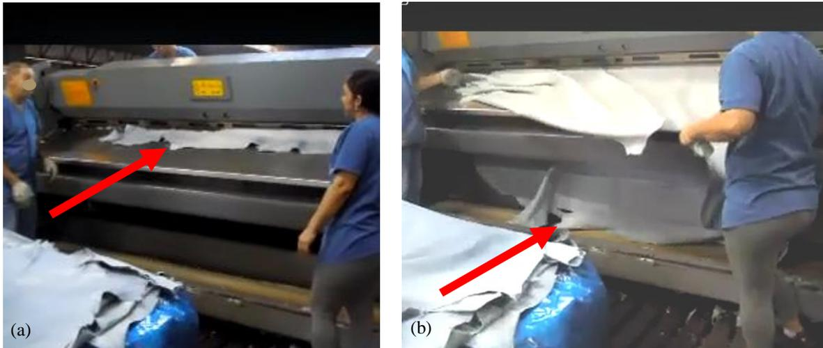
Figura 24 – Operação de divisão do couro curtido em camada flor em (a) e camada raspa em (b).
