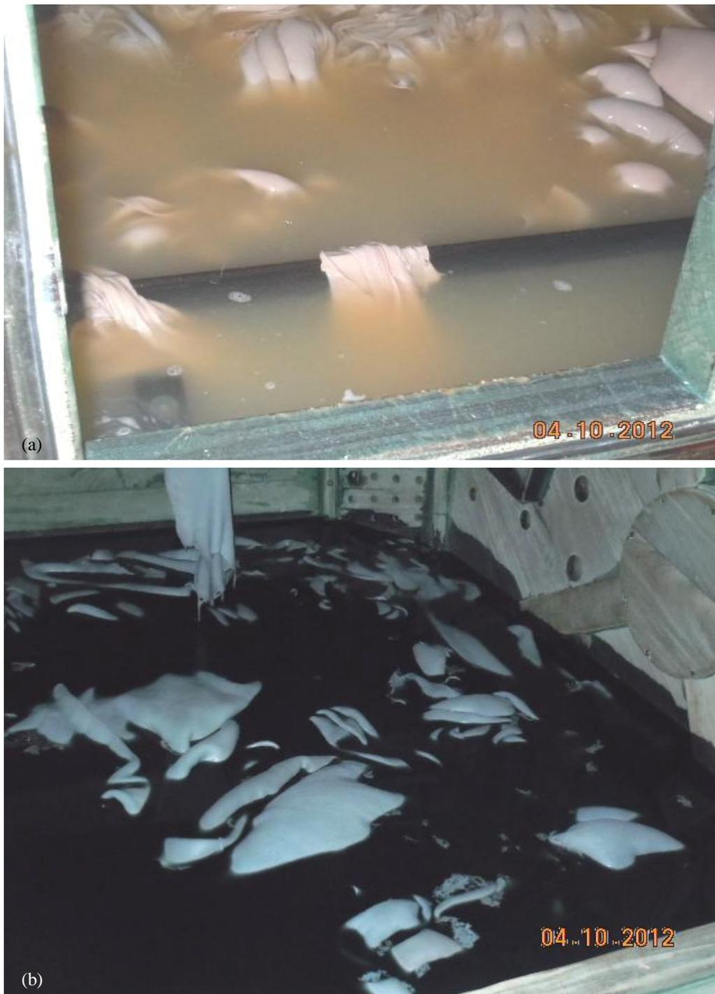
Figura 27 – Imagem no interior dos fulões (a), imagem das peles imersas em preparados químicos diversos (b), couro em banho de cromo.
