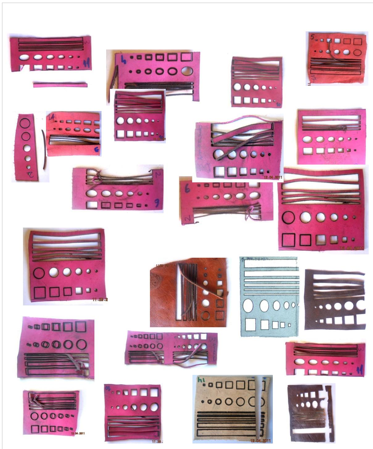
Figura 104 – Amostras iniciais cortadas a Laser.
