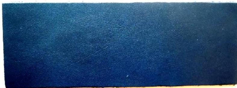
Figura 47 - Couro com acabamento de anilina. Fonte: Cartela Técnica de Couros ABQTIC, 1994
