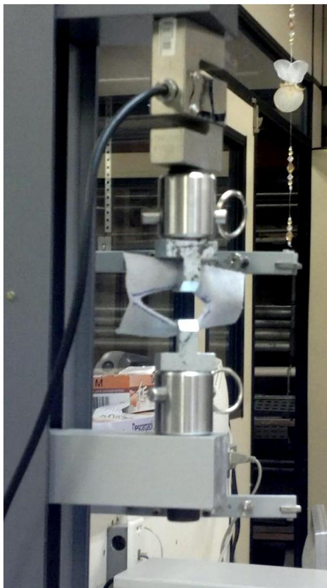
Figura 95 – Ensaio de rasgamento progressivo.
