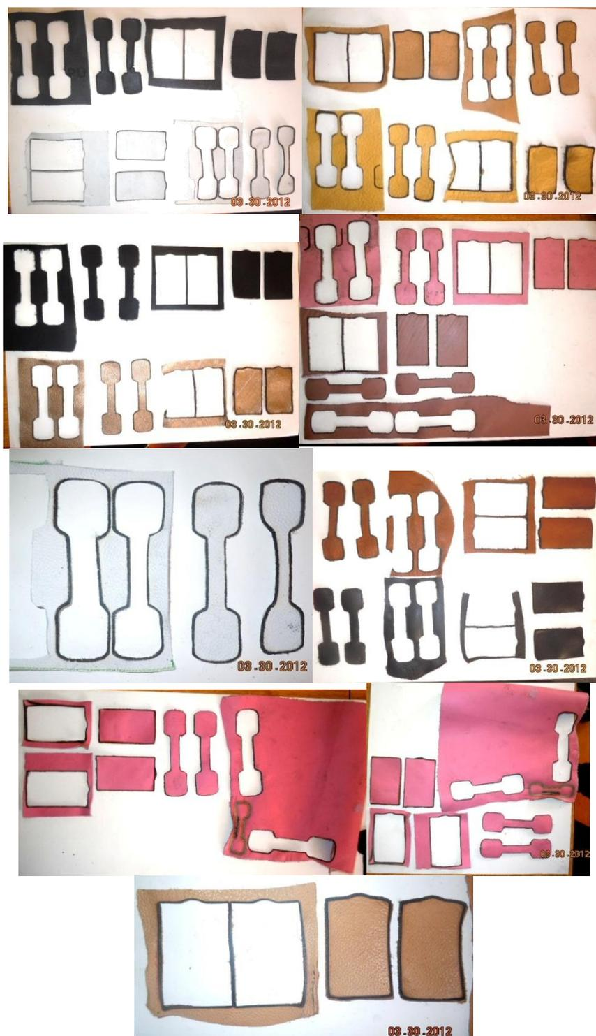
Figura 90 - Corpos-de-prova cortados a laser para os testes de tração e alongamento.
