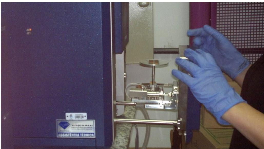
Figura 87 - Amostra sendo colocada no equipamento de microscopia eletrônica de varredura.
