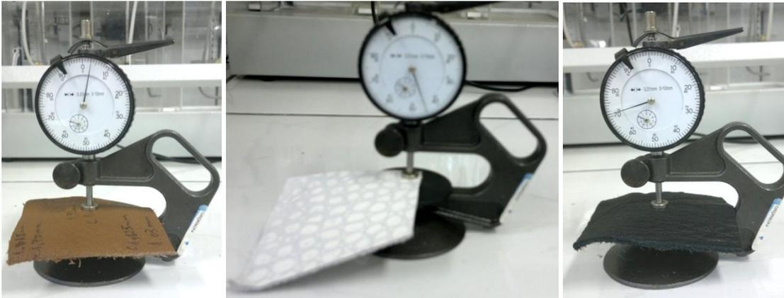
Figura 88 - Medição das amostras de couro com espessímetro.
