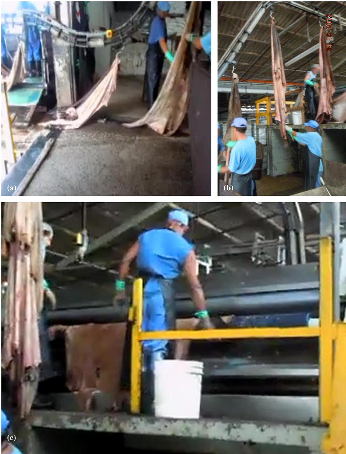
Figuras 25 - Entrada da pele no curtume (a), corte das aparas (b), pré-descarne mecânico (c).
