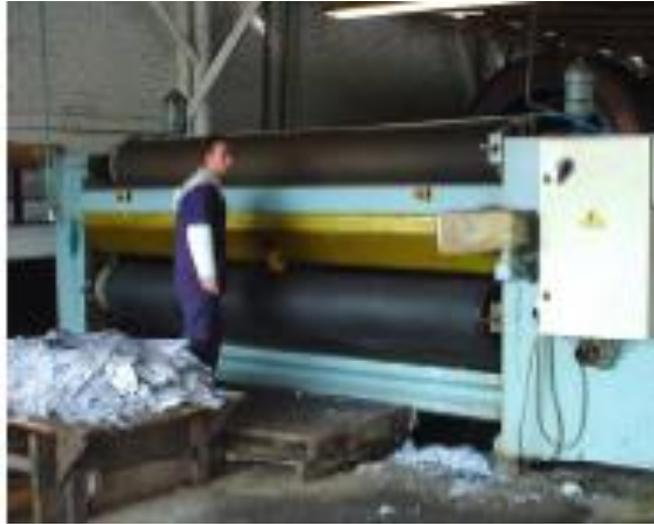
Figura 32 – Enxugamento do couro. Gutterres (2011)<sup>6</sup>.
