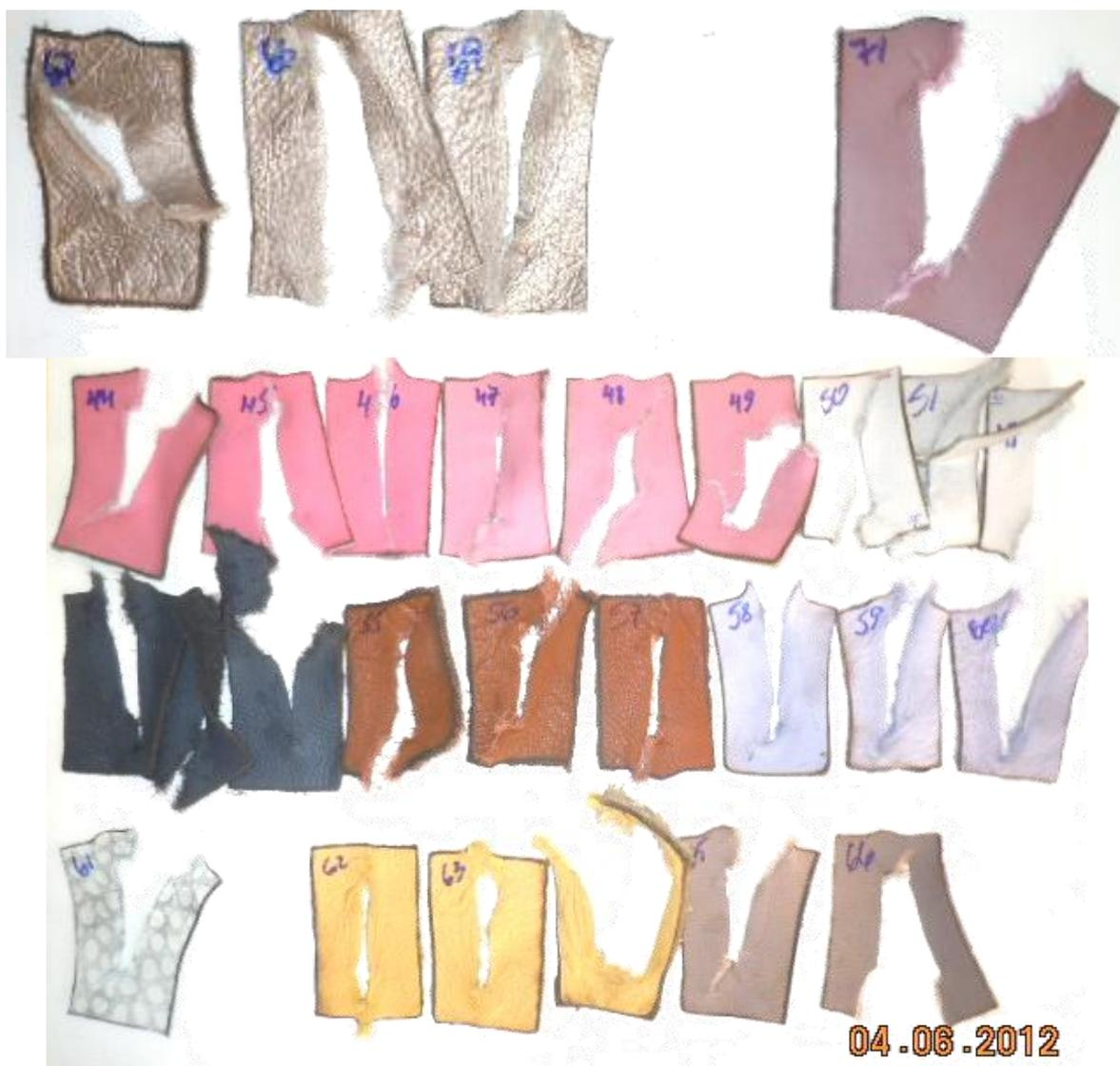
Figura 96 - Corpos-de-prova submetidos ao ensaio de rasgamento progressivo.
