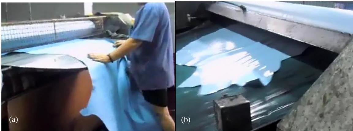
Figura 42 – Colocação do couro na máquina de pintura (a) e (b) couro com segunda mão de tinta.
