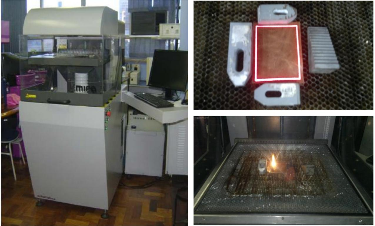
Figura 97 – (a) Equipamento de corte e gravação a laser, modelo Mira, marca Automatiza instalado nas dependências do LdSM/UFRGS; (b) Imagem do laser rastreando a área; (c) laser em funcionamento.
