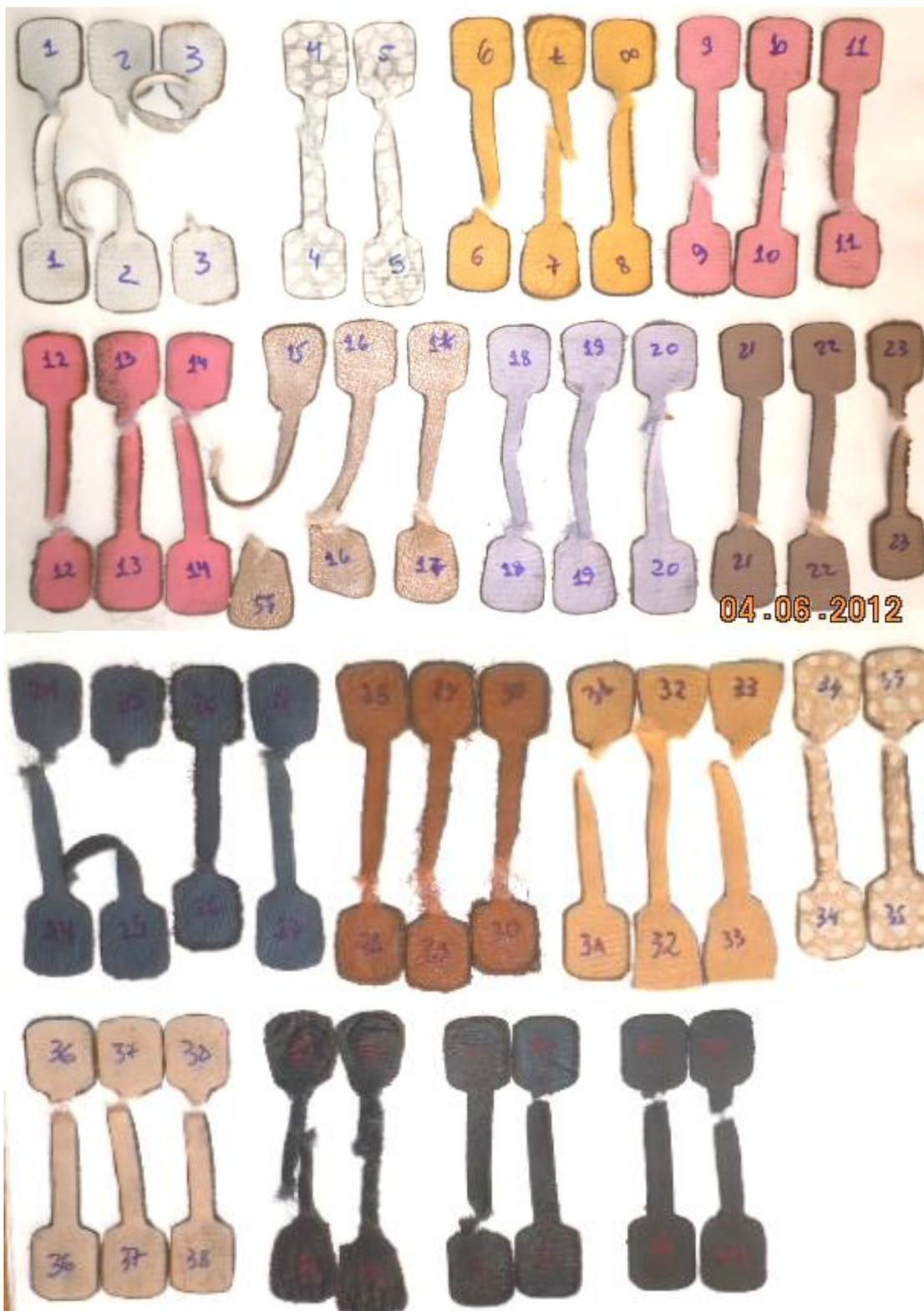
Figura 94- Corpos-de-prova submetidos ao ensaio de tração de alongamento.
