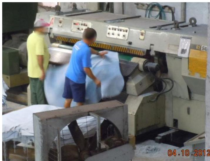
Figura 33 - Rebaixamento do couro.
