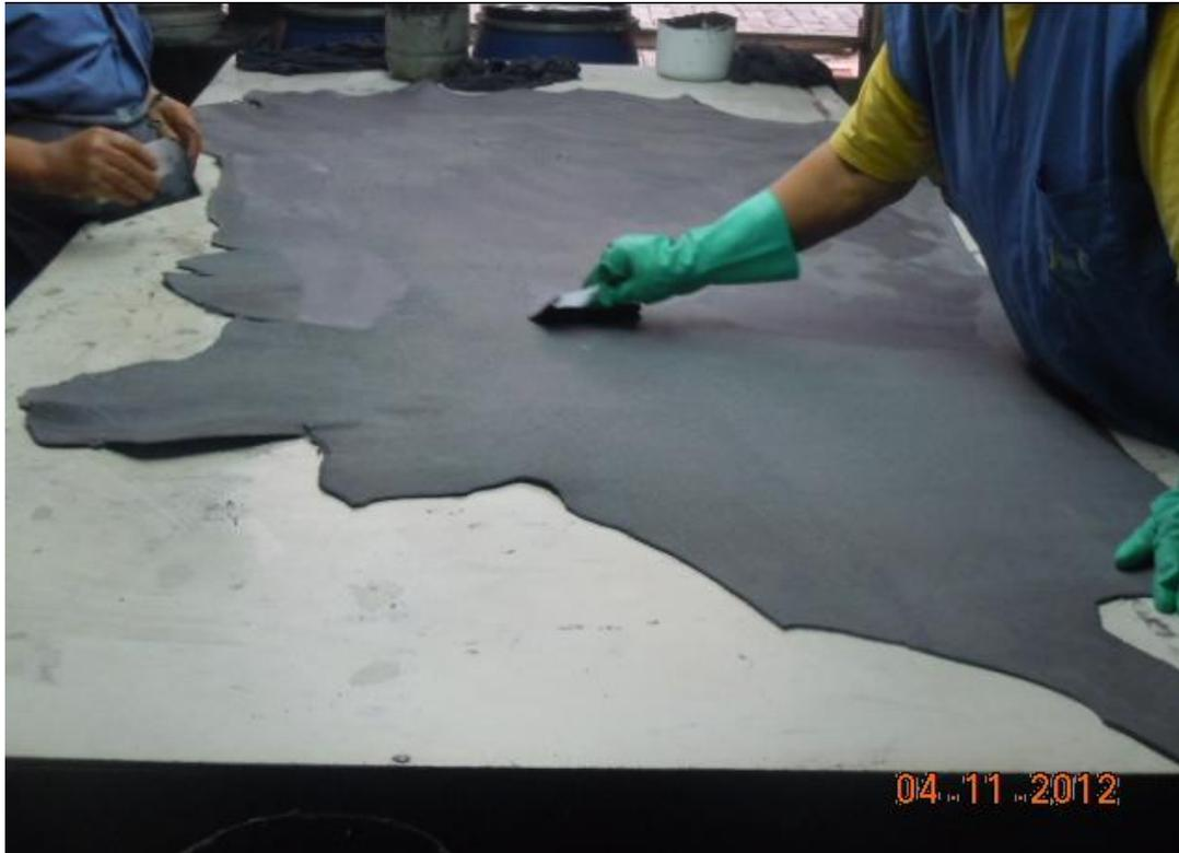
Figura 73 - Couro sendo estucado, imagem realizada no curtume Bom Retiro.
