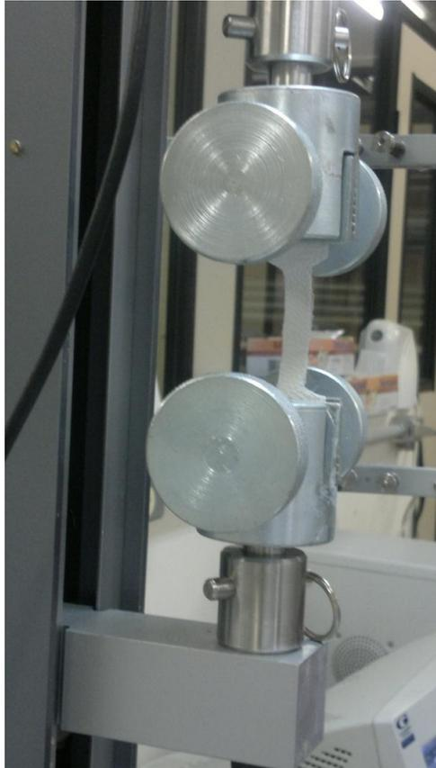
Figura 92 - Corpo-de-prova sendo alongado a fim de averiguar sua ruptura.
