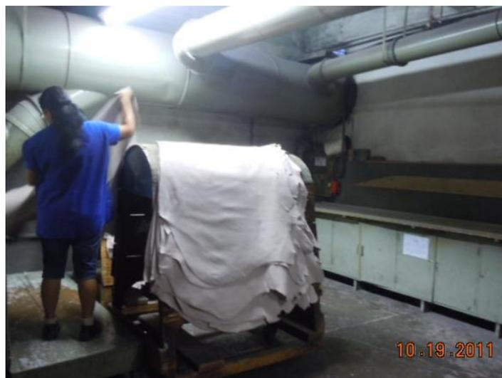
Figura 38 – Disposição dos couros em cavaletes.
