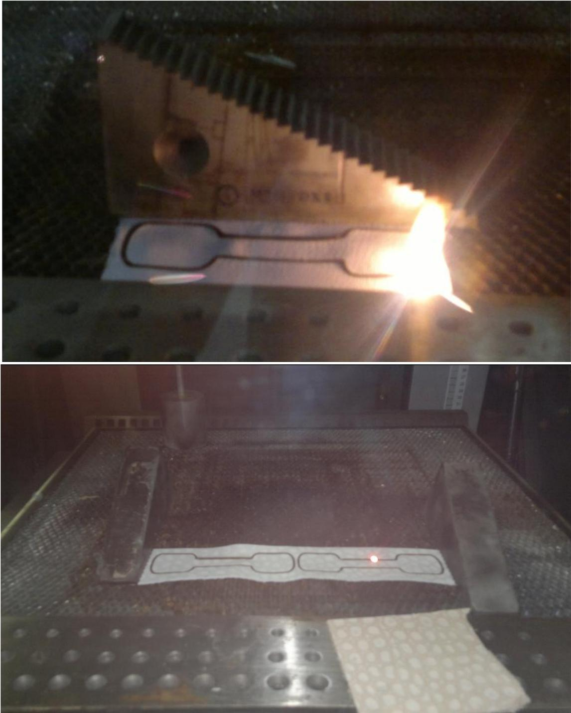
Figura 89 - Corpos-de-prova sendo cortados a laser para os ensaios de tração e alongamento.
