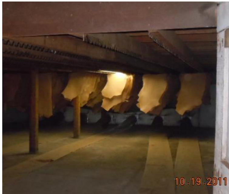
Figura 37 – Couros sendo secados.
