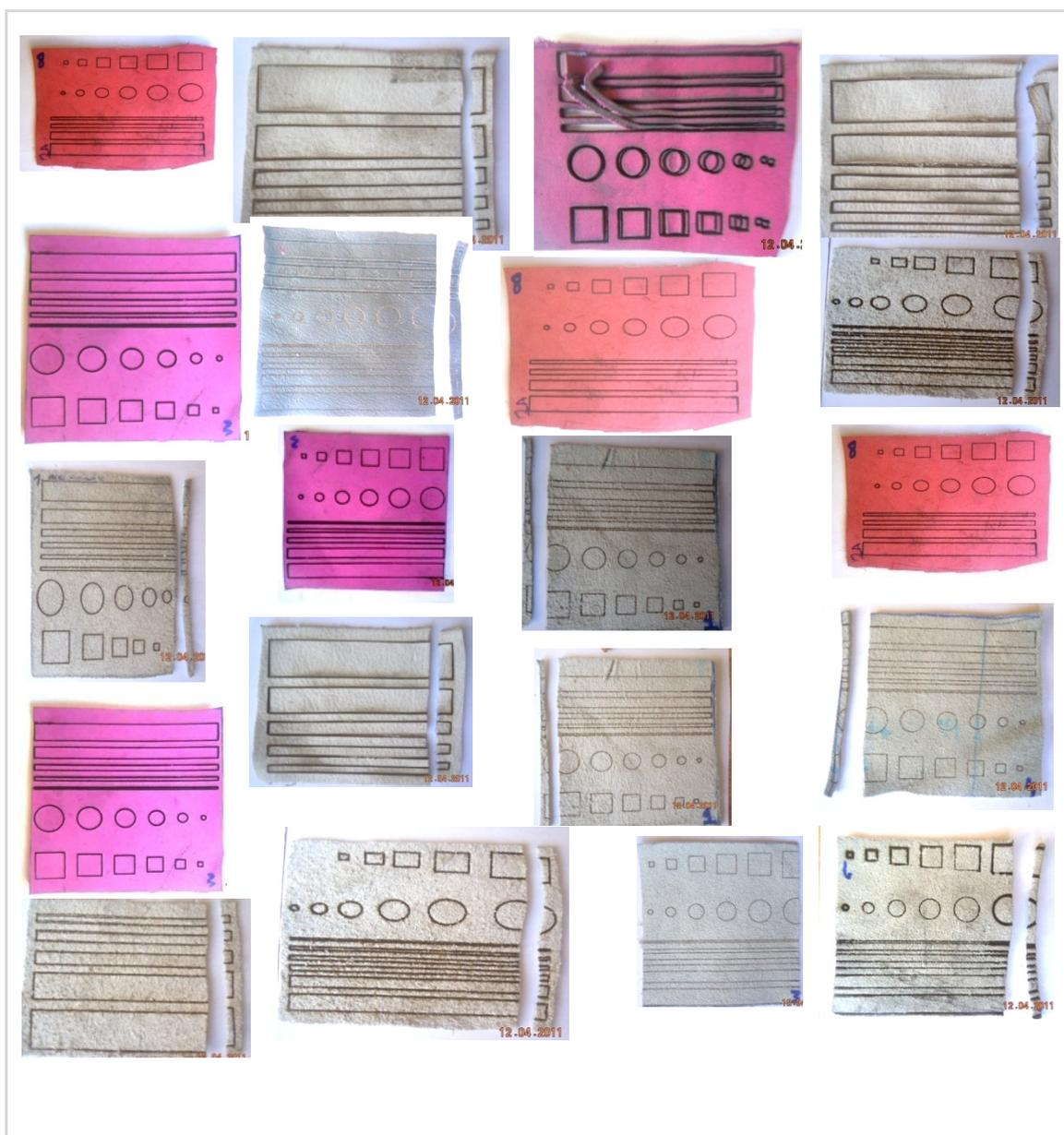
Figura 105 - Amostras de couro gravadas a laser do tipo raspa acabada e acabado.
