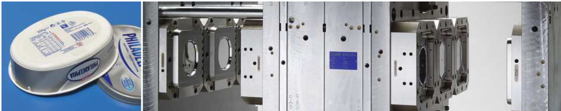
Figura 2.1 Molde para embalagem de queijo, com seis cavidades, em PP, tempo de ciclo 4,2 s.
