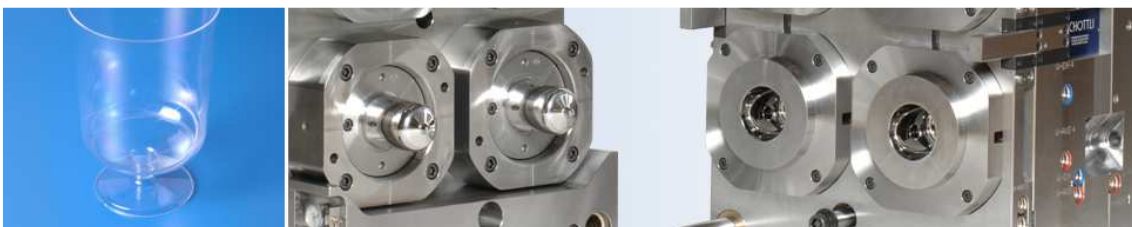
Figura 2.3 Molde para copos plásticos, com quatro cavidades, em PS, tempo de ciclo 4 s.
