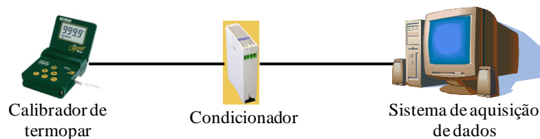
Figura 5.1 – Circuito empregado no ajuste estático do sistema de medição da temperatura.
