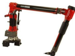
Figura 4.4- Sistema de medição tridimensional empregado no alinhamento dos dispositivos utilizados no projeto atual tribômetro.
