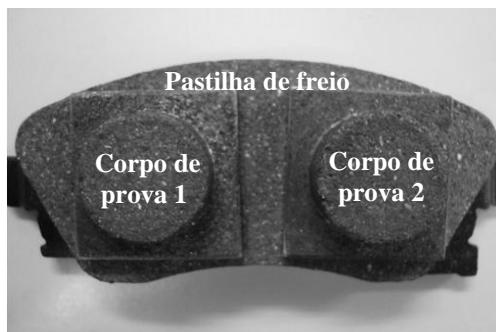
Figura 4.2 - Fotografia ilustrando a possibilidade de extração de dois corpos de prova de uma mesma pastilha de freio.
