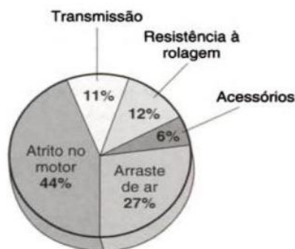
Figura 3.1 – Distribuição das perdas de energia de um automóvel [Adaptado: Hinrichs e Kleinbach, 2002].
