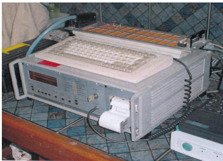
Figura 3.19 – Equipamento utilizado para aquisição dos dados medidos de alívio de deformação da superfície ensaiada. Unidade eletrônica de medição modelo UPM-100 da HBM. [LAMEF-Laboratório de Metalurgia Física-UFRGS].
