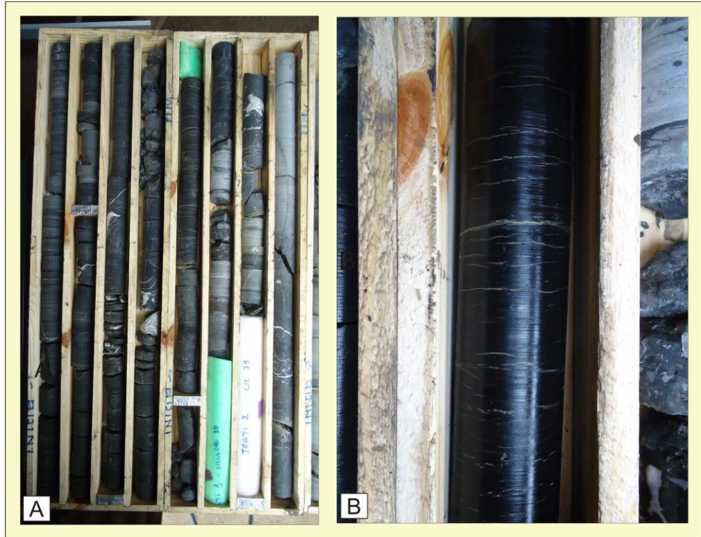
Figura 35. A) Final da Formação Estrada Nova, testemunhos do topo da Formação Irati; profundidade 280,80 – 288,90 m; B) detalhe do folhelho preto, 306 m de profundidade.
