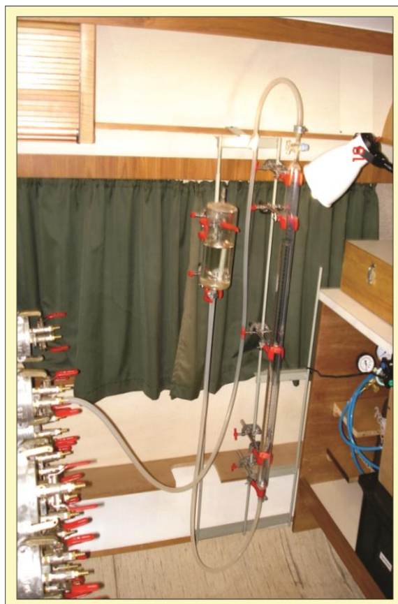
Figura 16. Coluna de vidro graduada ( \text{mm}^3 ) e reservatório de água em vidro borossilicatado utilizado para a medição do volume de gás metano em desorção dos cilindros.
