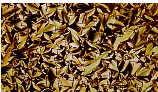
Figura 55. Esméctica A quiral com textura focal-cônica da amostra 36a no resfriamento (10x), a 50 °C.
