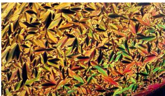
Figura 26: Esmética A quiral com textura focal-cônica da amostra 13a no resfriamento (40x), a 119 °C.
