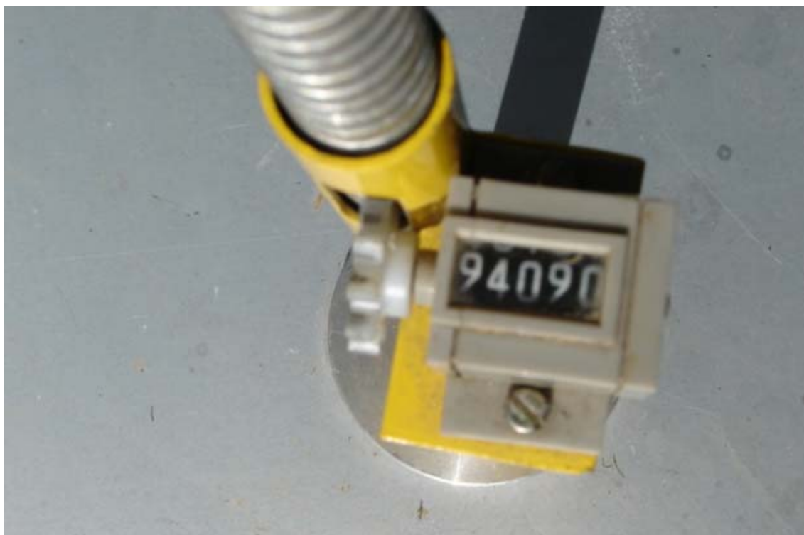
FIGURA 2. Detalhe do contador do disco medidor de forragem.
