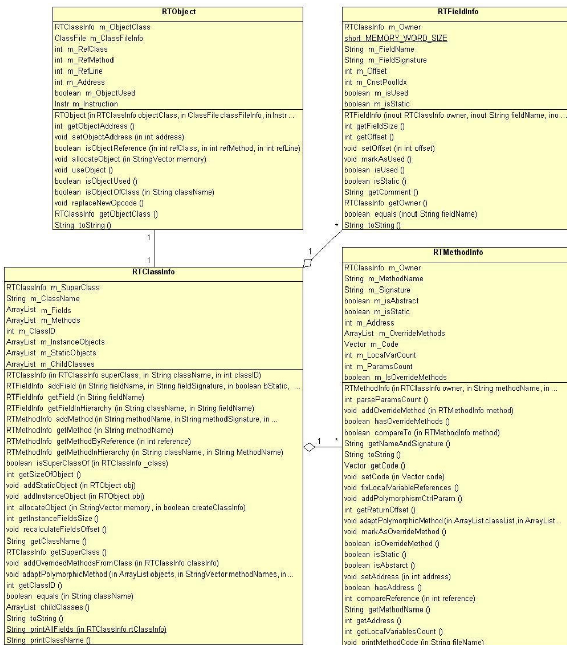
Figura 5.8: Diagrama de classes da nova estrutura de representação das classes no SASHIMI
