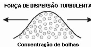
Figura 20 - Representação esquemática da força de dispersão turbulenta (Méndez et al, 2005).
