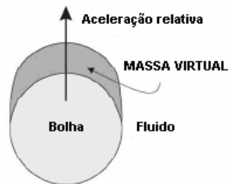
Figura 18 - Representação esquemática da força de massa virtual (Méndez et al, 2005).
