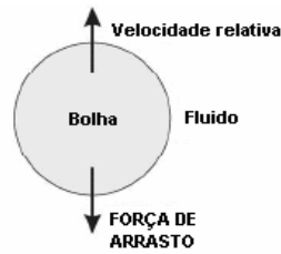
Figura 16 - Representação esquemática da força de arrasto (Méndez et al, 2005).
