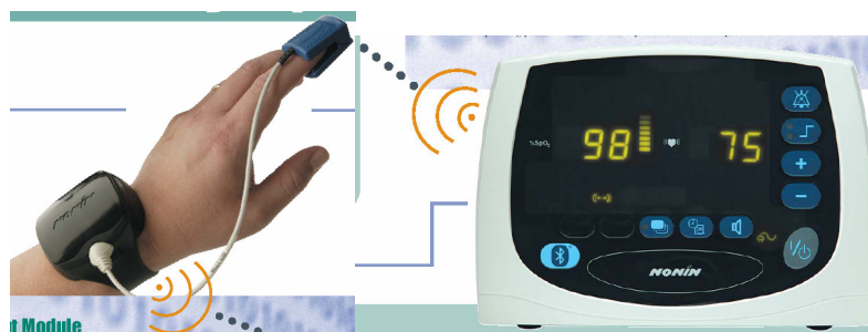
Figura 3. 3 - Sistema de oximetria de pulso do fabricante Nonin. Unidade Slave Avant 4100 , móvel e unidade Master Avante 4000 , estacionária. Utilizando tecnologia sem fio Bluetooth versão 1.1
