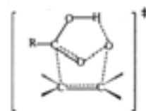
Figura 6. Estado de transição envolvendo uma adição 1,3-dipolar para a epoxidação de uma olefina por um perácido 26 .
